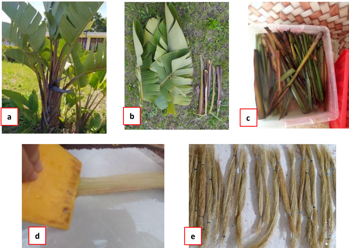
Figure II. 3 Les étapes d'extraction: (a) arbre d'oiseau du paradis, (b) tiges coupées, (c) rouissage, (d) brosseuse et (e) séchage.
