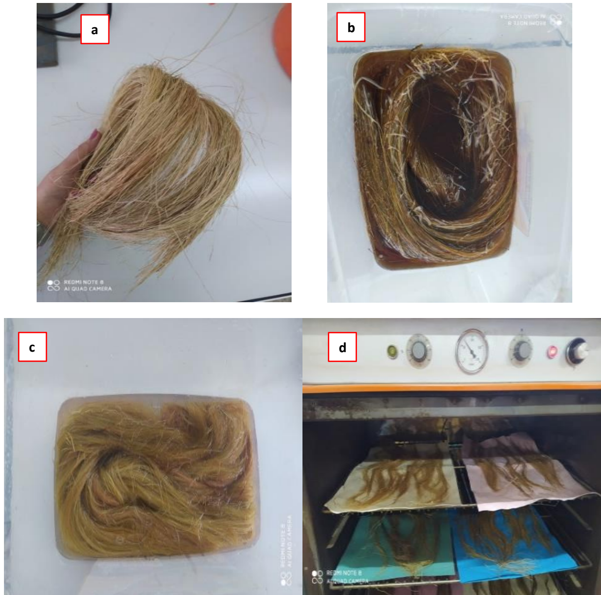
Figure II. 4 Les étapes du traitement alcalin: (a) fibres séchées, (b) solution de NaOH, (c) neutralisation et (d) séchage dans l'étuve.
