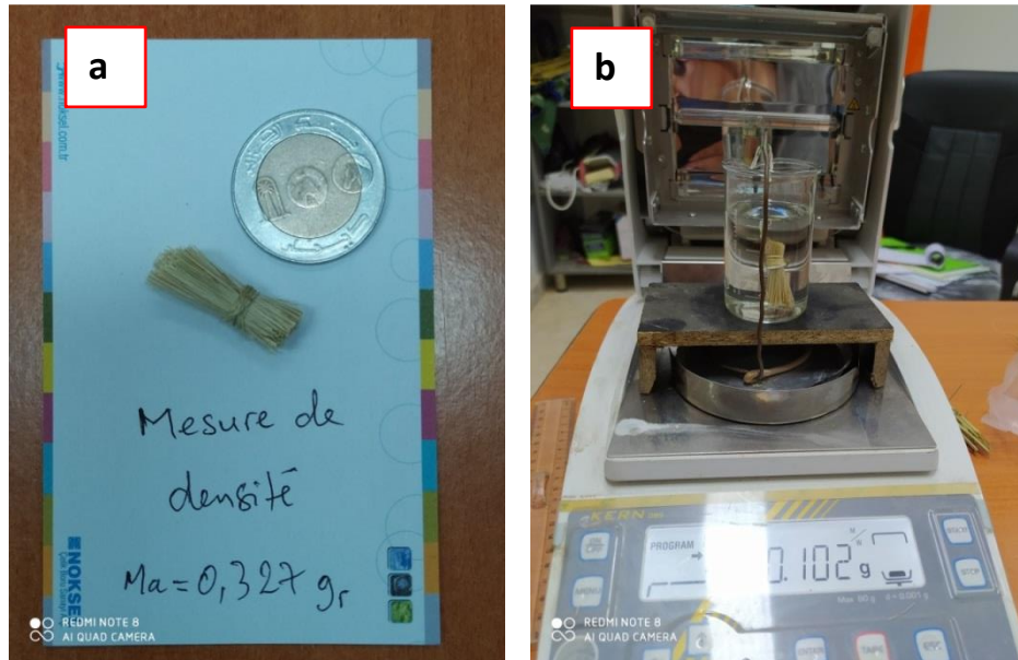
Figure II. 7 Mesure de la densité des fibres : (a) échantillon à tester (b) Banc d'essai pour la détermination de la densité
