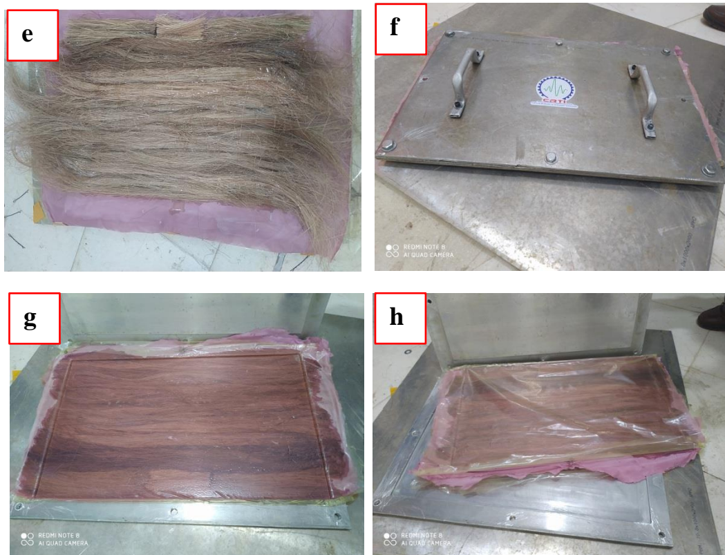
Figure II. 15 Différentes étapes de préparation des plaques composites Strelitzia reginae /époxy
