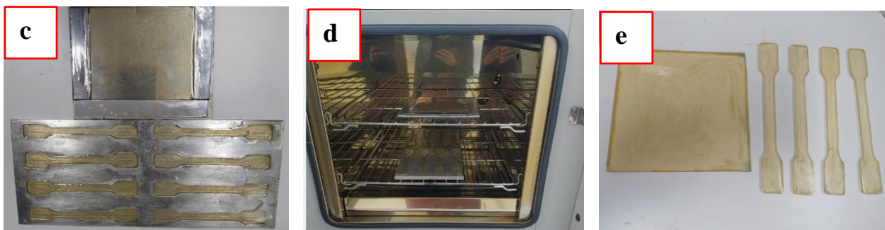
Figure II. 14 Etapes de préparation de la résine : (a) agent démoulant, (b) mélange résine-durcisseur, (c) moulage, (d) durcissement, (e) démoulage des éprouvettes
