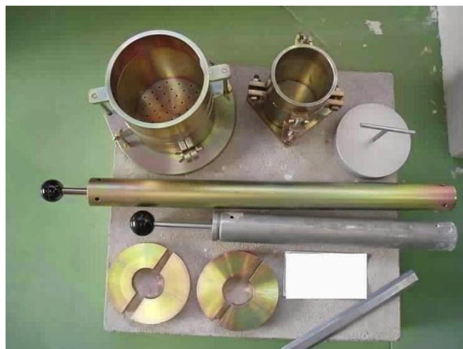
FIGURE IV.6 : L'ESSAI PROCTOR
