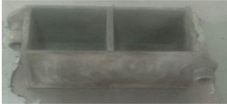
**Figure 2.9** Moule de béton cubique
