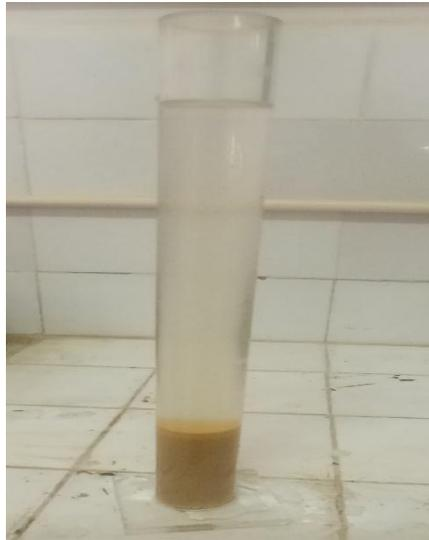
**Figure1.13** Essai de la masse volumique absolue de sable
