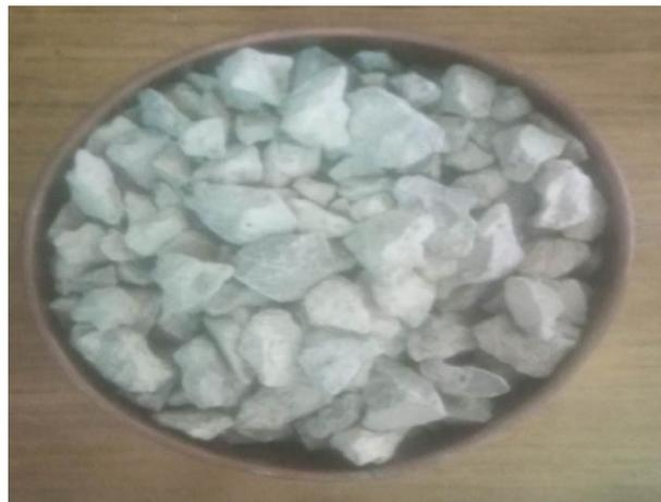
**Figure1.11** Essai de détermination de la masse volumique apparente de gravier 8/15
