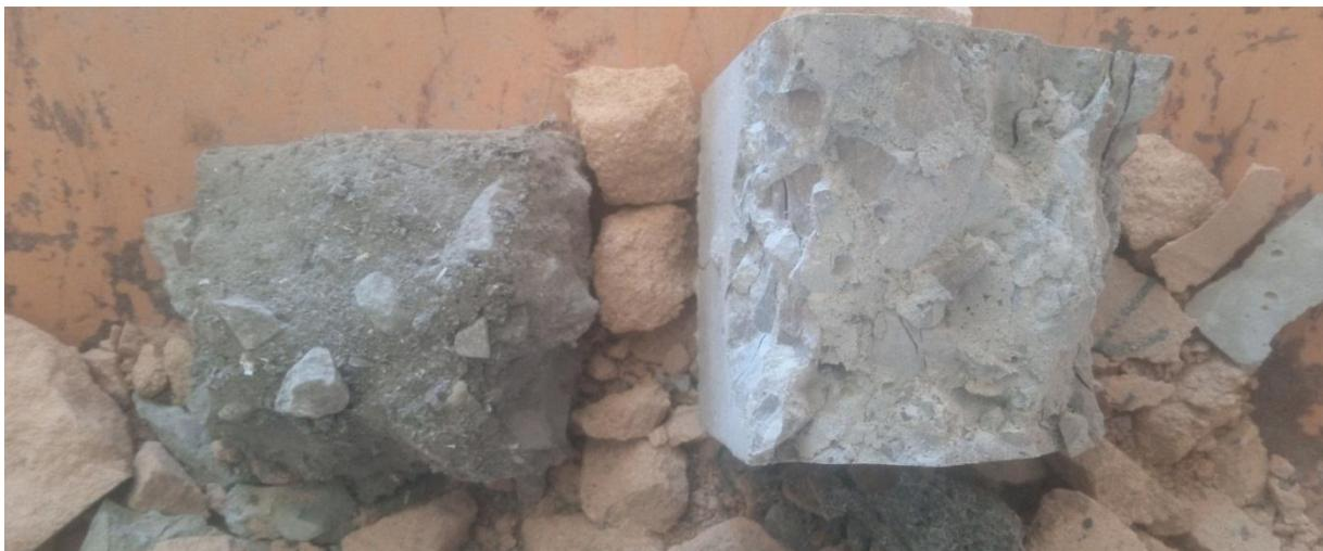
**Figure 4.2** éprouvette après la compression
