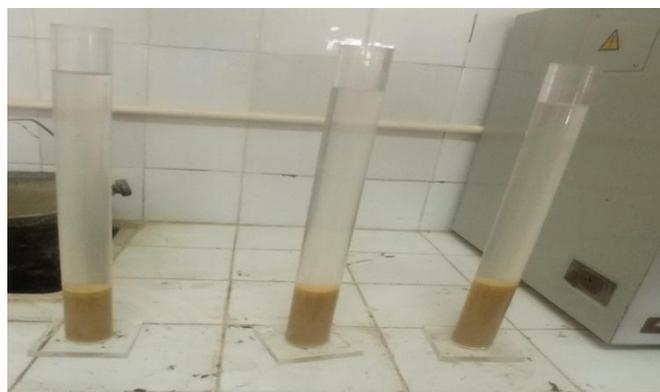
**Figure1.15** Essai d'équivalent de sable
