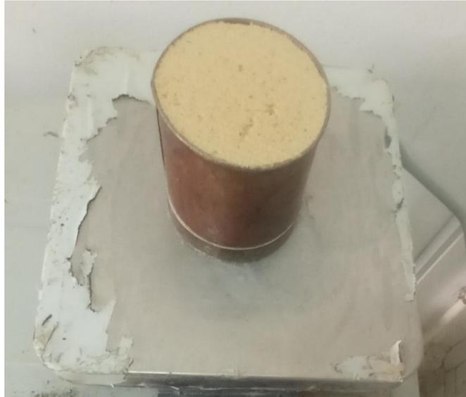
**Figure1.9** Essai de détermination de la masse volumique apparente de sable
