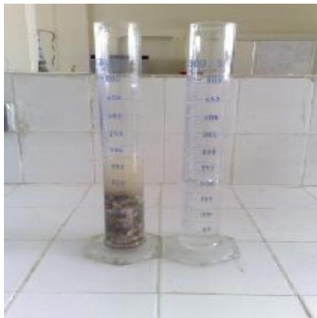
**Figure1.14** Essai de la masse volumique absolue de gravier
