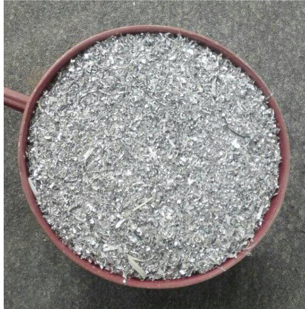
**Figure 1.12** Essai de détermination de la masse volumique apparente de déchets d'aluminium
