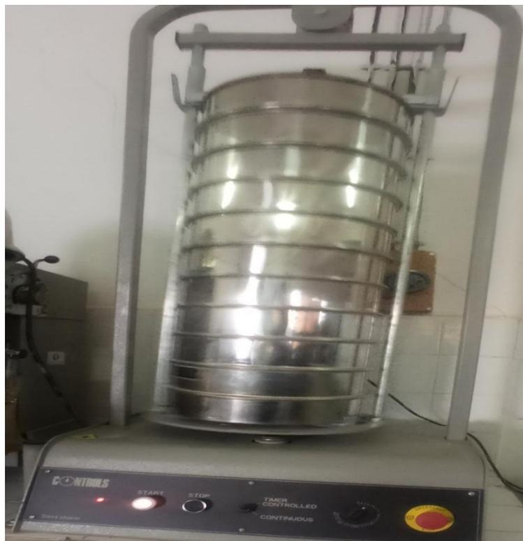
**Figure1.7** Analyse granulométrique
