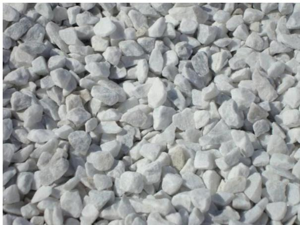
**Figure1.3** gravier 8/15 d'origine de la carrière
