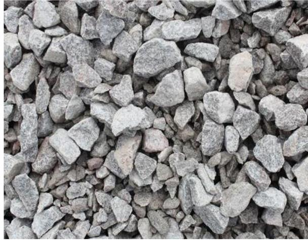
**Figure 1.4** gravier 15/25 d'origine de la carrière
