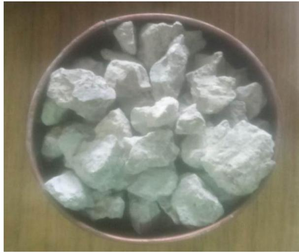
**Figure1.10** Essai de détermination de la masse volumique apparente de gravier 15/25
