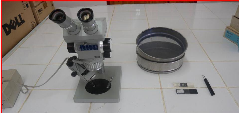
Figure08. Matériel nécessaire au lavage et en tri des microfossiles des roches meubles
