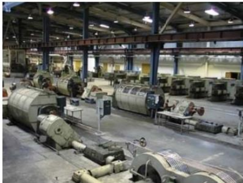
Figure III.1: Tréfileuse horizontale de type DZWG1250/10 ,1.
