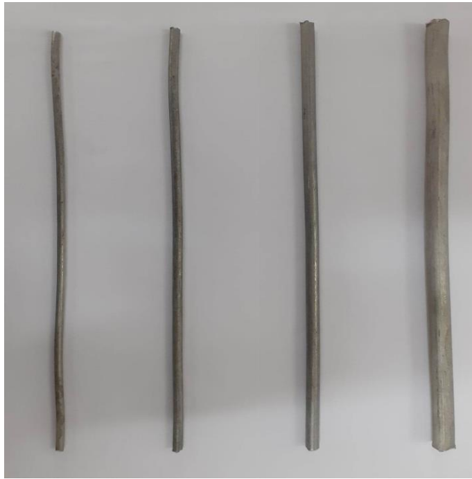
Figure III.2: Eprouvettes des fils d'aluminium tréfilés.
