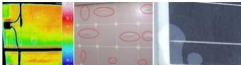
Figure III.15 : Défaut bulle d'air .
