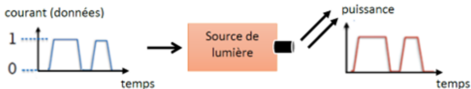
Figure. 1.3 – Principe de base d’une modulation d’intensité .
