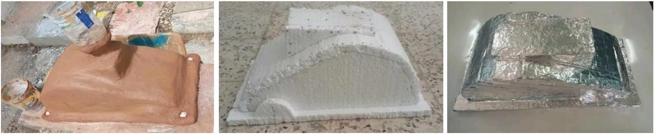
**Figure V. 5 :** Autres modèles que nous avons essayés (on argile et on polystyrène).
