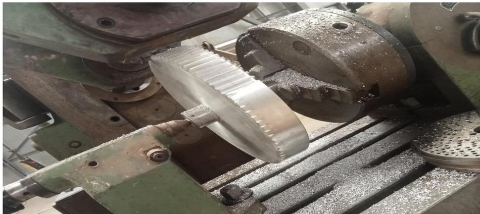
Figure V. 26 : Une photo montrant le taillage des engrenages.
