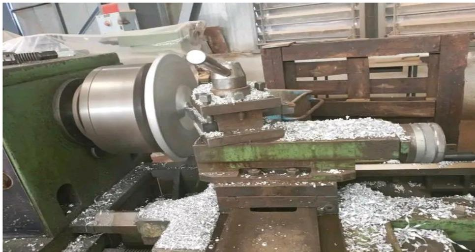
**Figure V. 24 :** l'usinage des pièces cylindriques.
