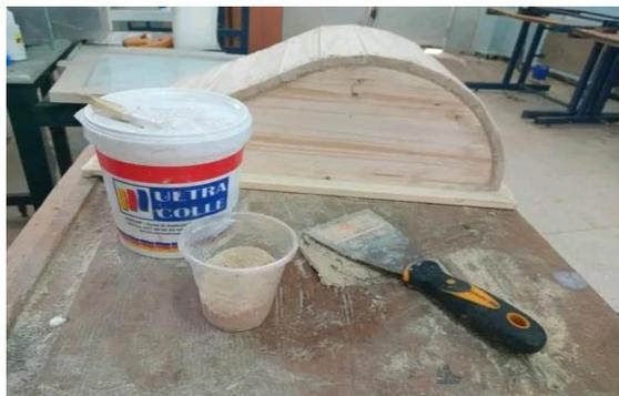
Figure V. 4 : Méthode pour combler les lacunes dans le modèle en bois.
