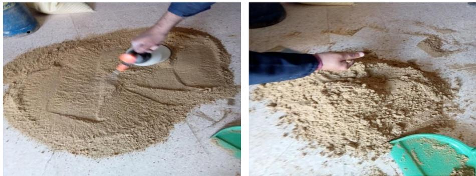
Figure V. 2 : Méthode de mélange des composants du sable.
