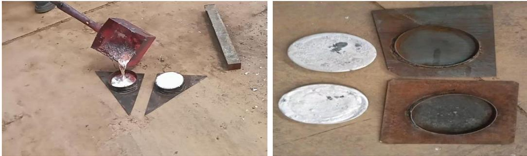
**Figure V. 22 :** Le processus de préparation de brut des engrenages.
