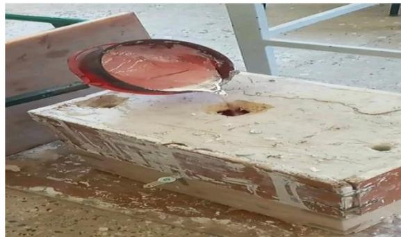
Figure V. 13 : Le processus de coulée d'aluminium fondu dans le moule.
