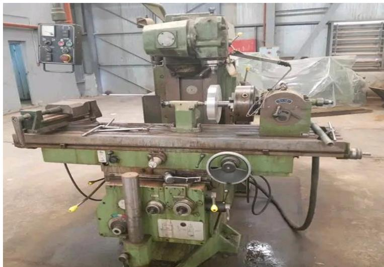
Figure V. 20 : Une photo montrant la fraiseuse avec lequel les engrenages ont été fabriqués.
