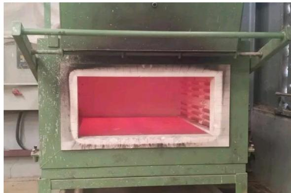
**Figure V. 23 :** Four des traitements thermiques
