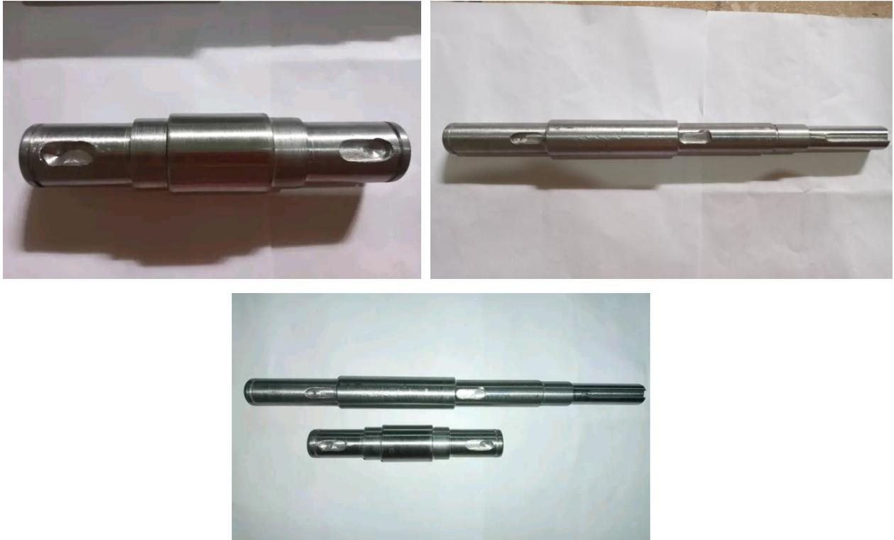
**Figure V. 18 :** Photos des axes (arbres) finies.
