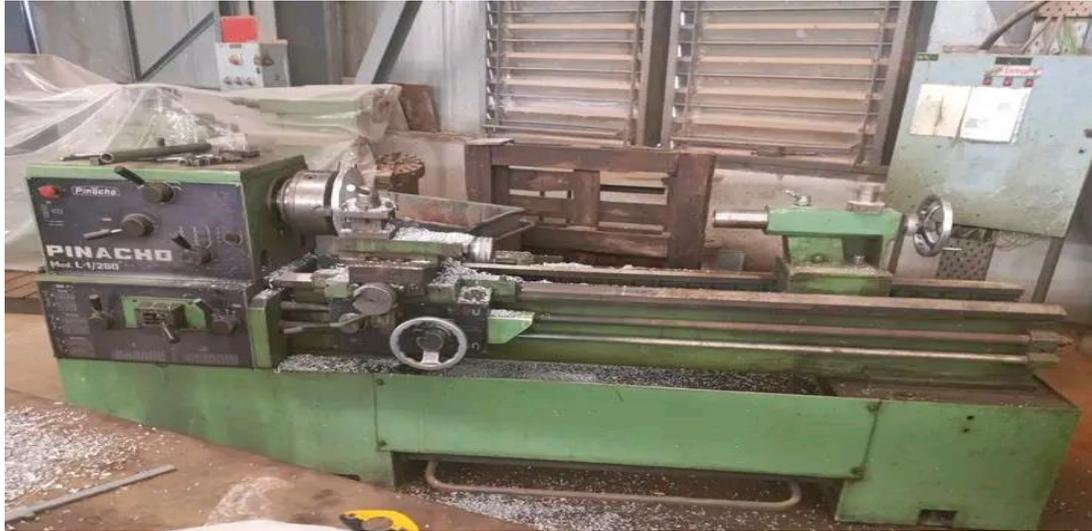
**Figure V. 16 :** Une photo montrant le tour avec lequel les arbres ont été fabriqués.
