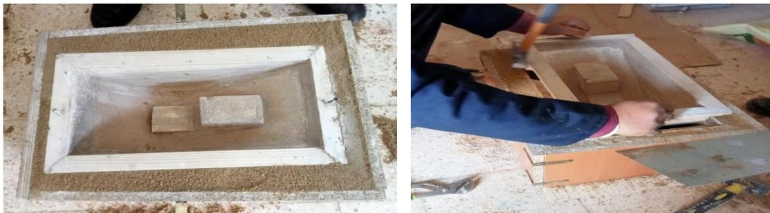
Figure V. 10 : Le processus de préparation de l'empreinte supérieure.
