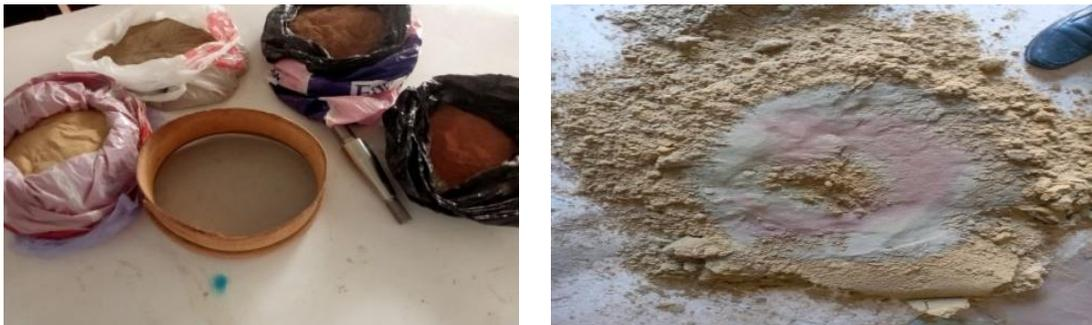
Figure V. 1 : Composants du sable de moulage.
