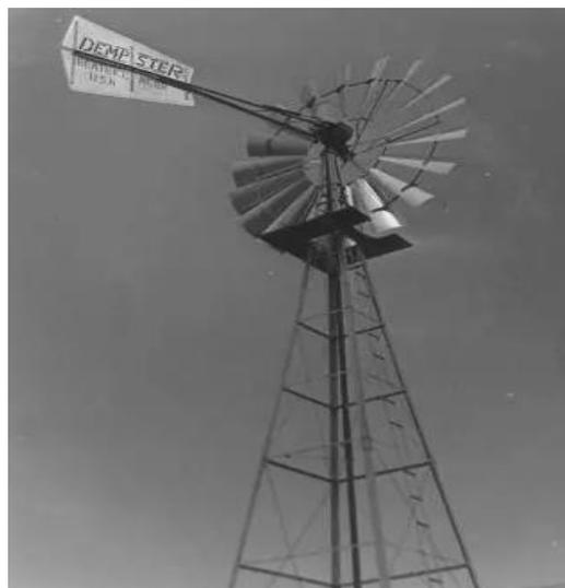
**Figure I. 24 :** Eoliennes à pompage d'eau. [30]
