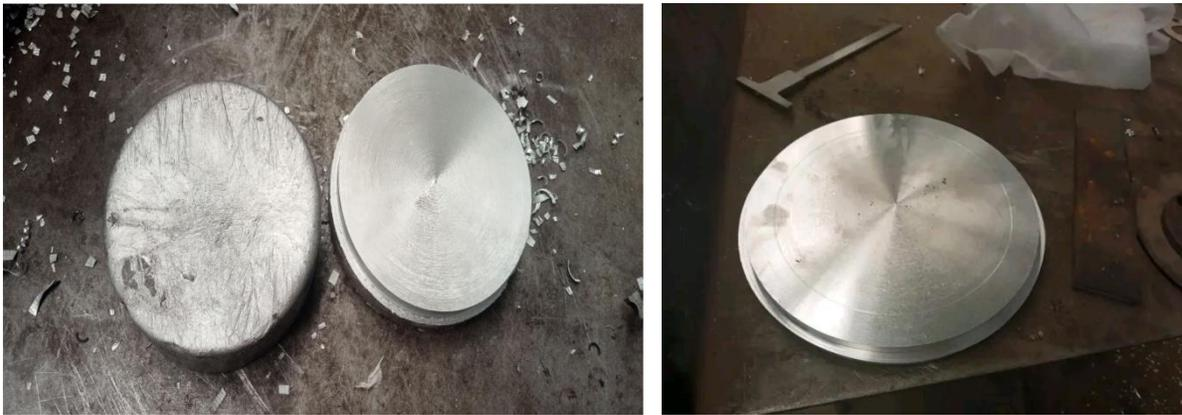
Figure V. 25 : Les pièces cylindriques avant et après l'usinage
