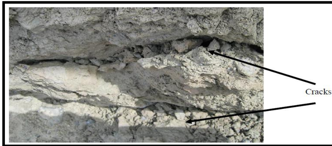
Figure III.06: fissure provoqué par le gel - dégel (Jantzer, 2005)
