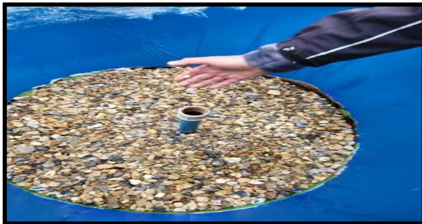
Photo III.07: le piézomètre pour mesuré la charge hydraulique
