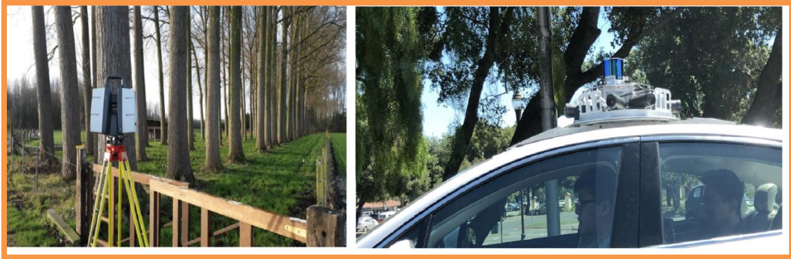
Figure 41 : la gauche :Une image de l'étude en terrain utilise une capteur Lidar statique de mark Leica - P40 et dans l'image droite :Une image représente une capteur lidar mobile d'après :Jeffrey Verbeurgt (l'image gauche) et Mario Herger (l'image droite)
