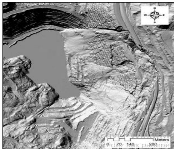
Figure 67 : Surveillance LiDAR aéroporté (ALS) du mur Est de la mine LAB Chrysotile après la rupture du 12 juillet 2012.
