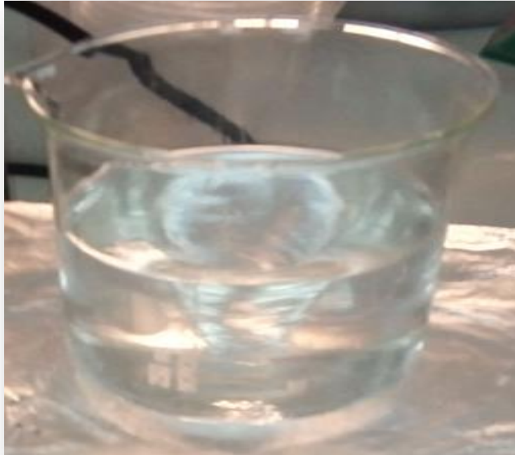
شكل 2.2. مظهر محلول الرش (إذابة خلات أكسيد الزنك في الميثانول بعد عملية الخلط بالتأثير المغناطيسي).
