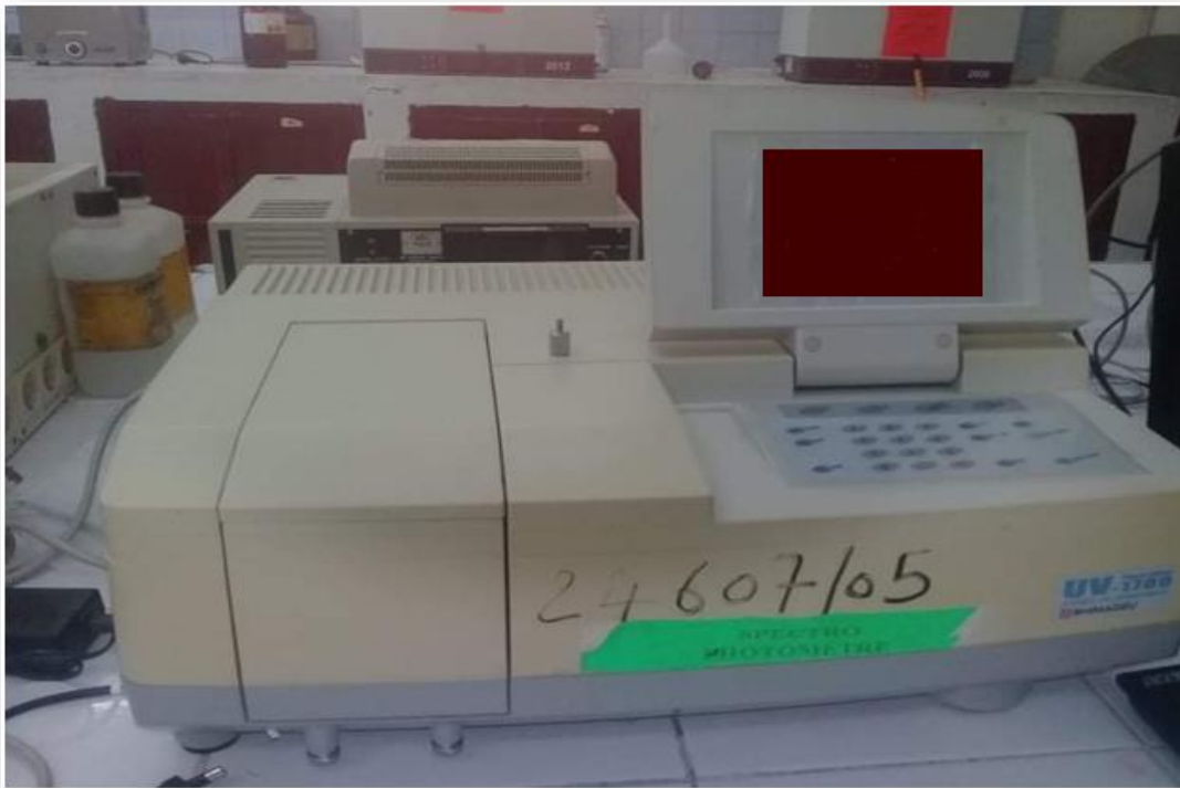
شكل 6.2. جهاز مطيافية الأشعة فوق البنفسجية و المرئية SHIMADZU (UV-1700)
