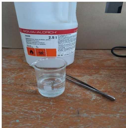
Figure (II-3) : Nettoyer le substrat avec du méthanol
