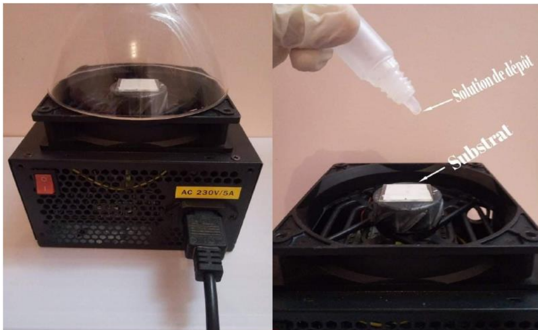
Figure II. 2: Dispositif expérimental de spin coating des couches utilisé au Laboratoire de Physique appliquée et théorique, Université Echahid Cheikh Larbi Tébessi-Tébessa.
