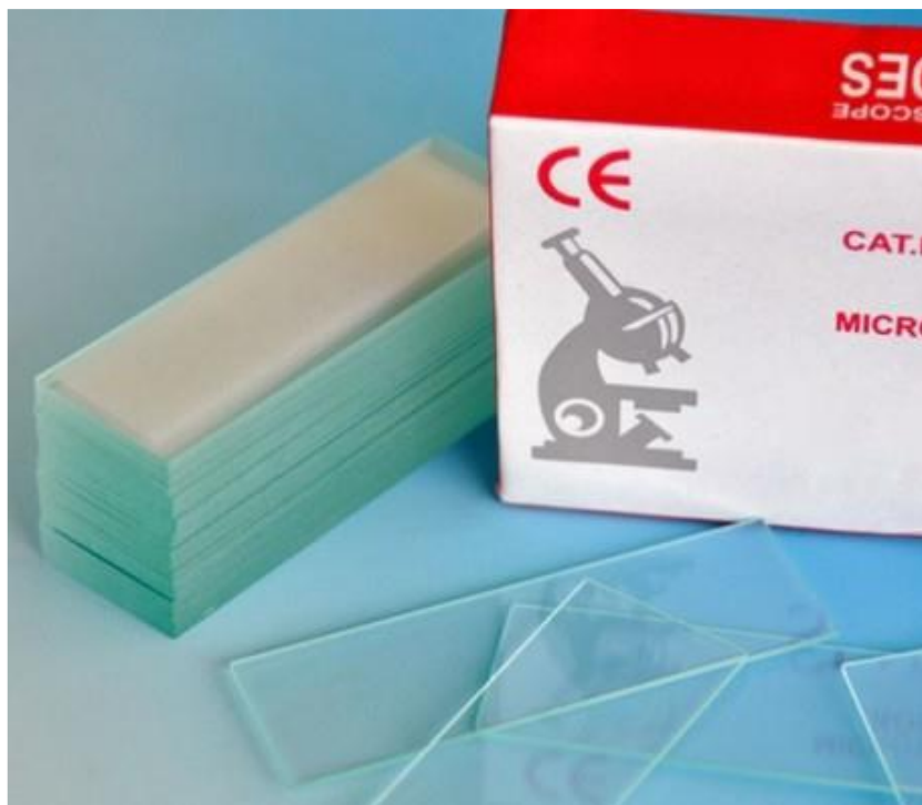
Figure II. 1: Lames de verres utilisés, avec épaisseur 1mm, taille 25 x 76 mm
