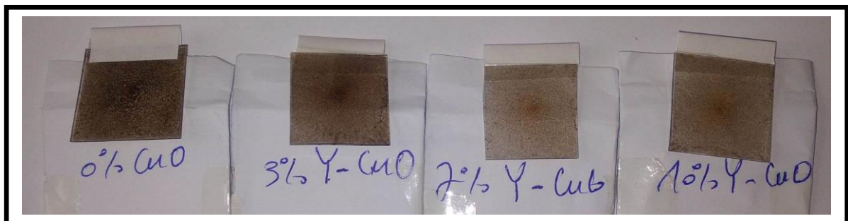
Figure II. 5: Une photographie des échantillons de CuO dopé Y (0, 3, 7 et 10% wt.) déposés sur les verres par spin-coating.
