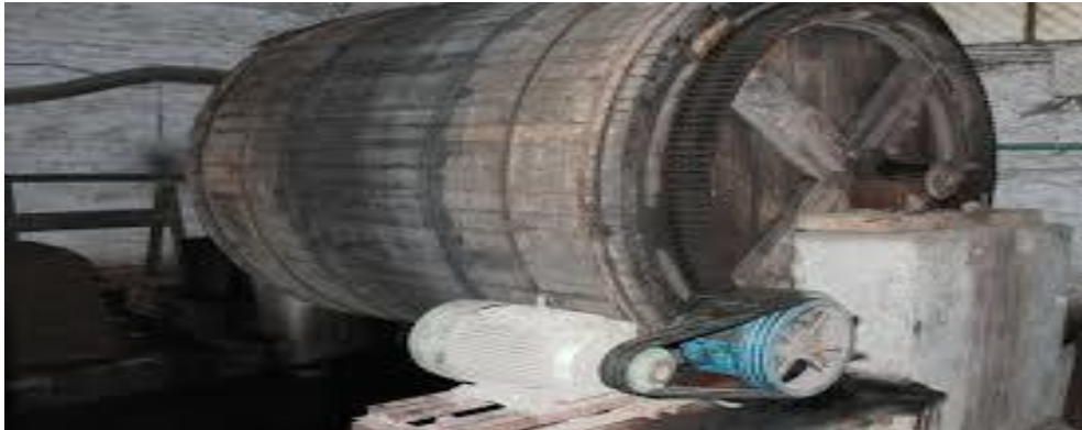
Figure II.4 : Principe fonctionnement de froulon [3]
