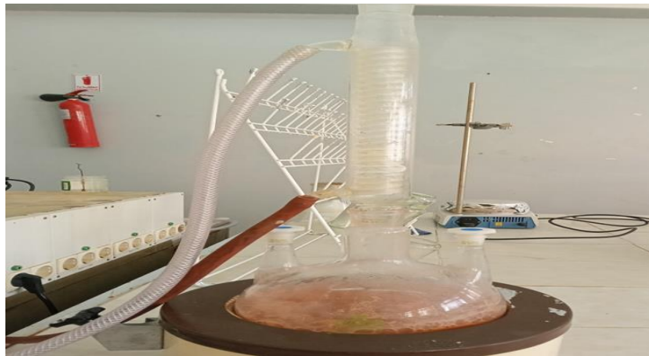
Figure 7 : Montage de chauffage à reflux.
