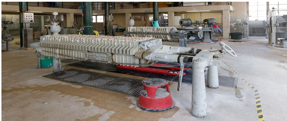
Figure IV.5 : Le filtre presse [7]
