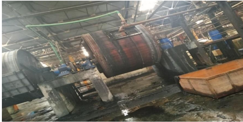
Figure I.8 : Foulons de tannage
