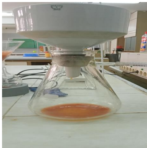
Figure 8 : Filtration sous vide.
