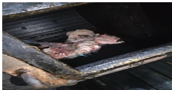
Figure15 : Trempe dans le foulon
