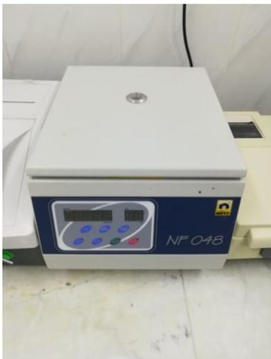
Une centrifugeuse de laboratoire est un dispositif permettant de séparer en différentes phases les éléments d'une solution grâce à leur différence de densité.
