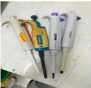
Une pipette est un outil de laboratoire utilisé en chimie, en biologie et en médecine pour transporter un volume mesuré de liquide. Les pipettes sont disponibles en plusieurs modèles avec différents niveaux de précision. Elles peuvent être simples, en plastique ou en verre, ou électroniques.
