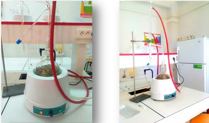
Figure 23 : Montage d'un hydro distillateur de type clevenger
