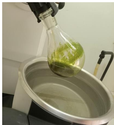
Figure 13 : Dispositif d'extraction des extraits par solvant de type évaporateur rotatif (Photo personnelle)
