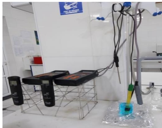
Figure 08. Potentiomètre utilisé pour mesurer le pH des échantillons des boissons aromatisées.
