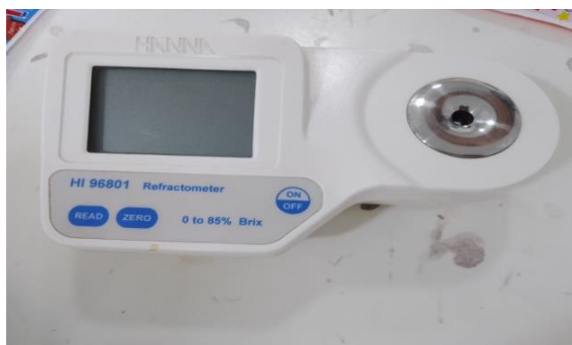
Figure 09. Réfractomètre digitale « HANNA, HI96801 » utilisé pour mesurer le taux de sucre des échantillons des «Boissons aromatisées ».
