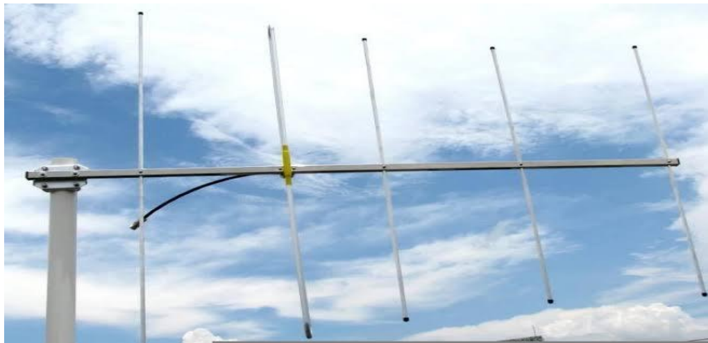
Figure I .12 : antenne à élément parasite
