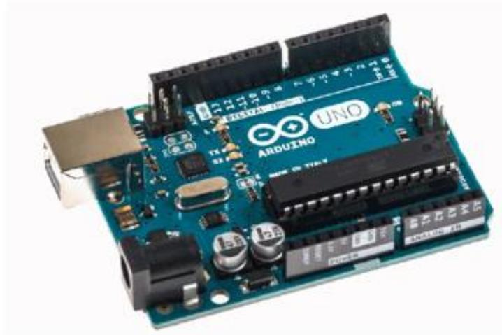
**Figure 2.3 :** La face composante d'une Arduino Uno R3
