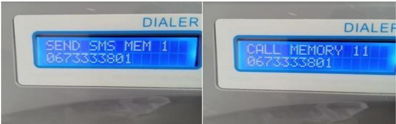
Figure 3.13 Notification et appelle par GSM
