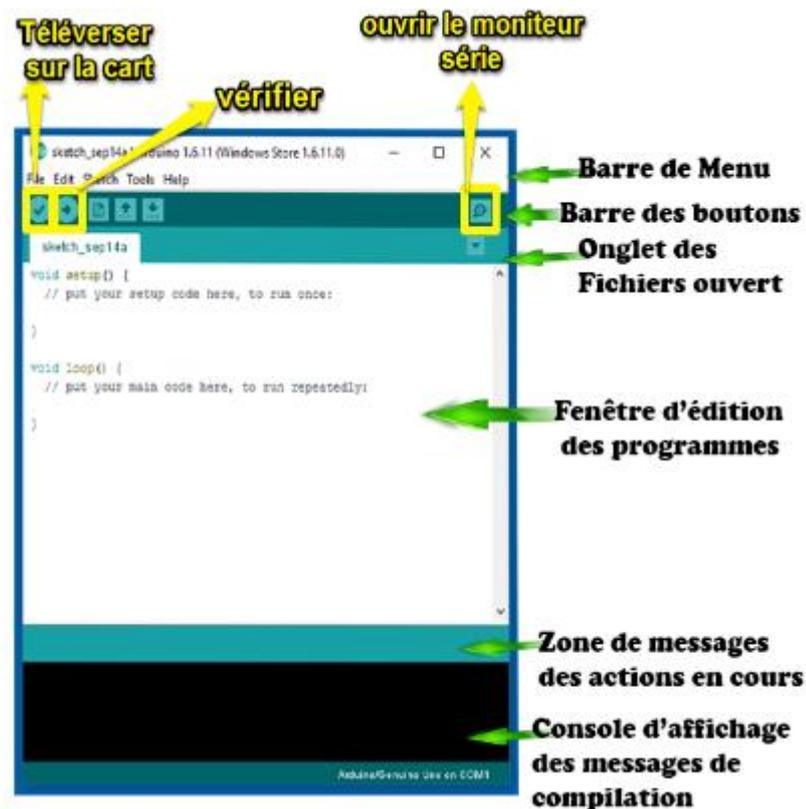
Figure 2.7 : Interface de programmation ARDUINO IDE
