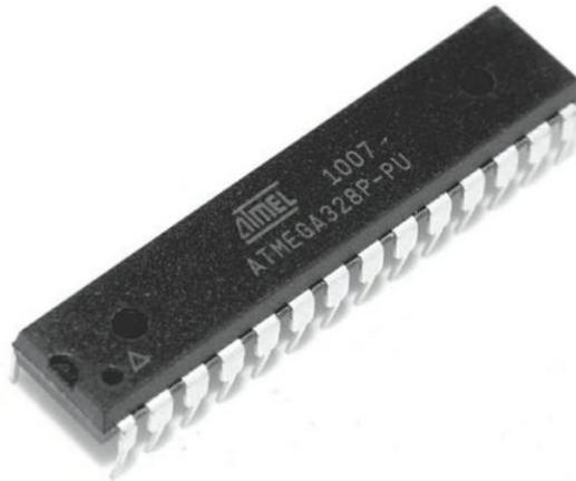
**Figure 2.8** : Un microcontrôleur ATmega328
