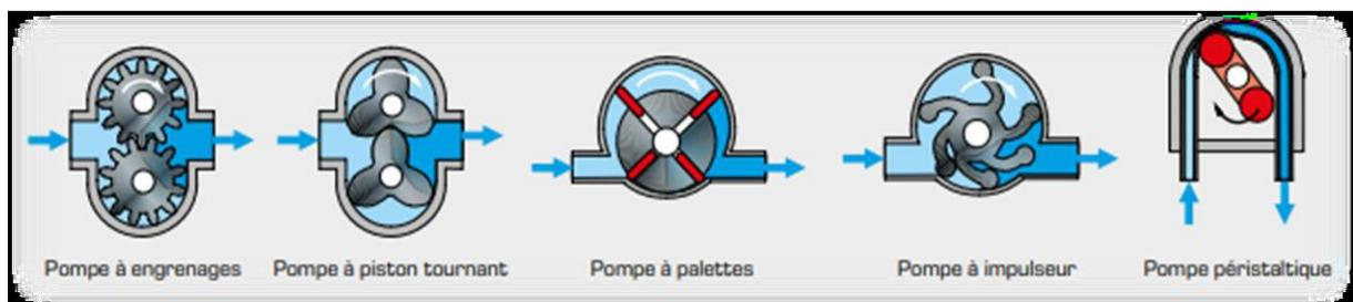
Figure II.5 : Fonctionnement de quelques types de pompe volumétrique [27]
