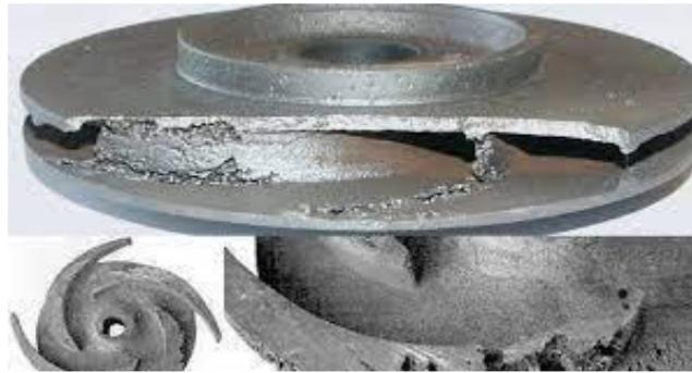
**Figure (IV.9):** cavitation de pompe centrifuge
