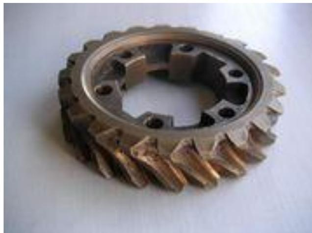
Figure 3.19. Dégradation des dents d'une roue dentée.[62]
