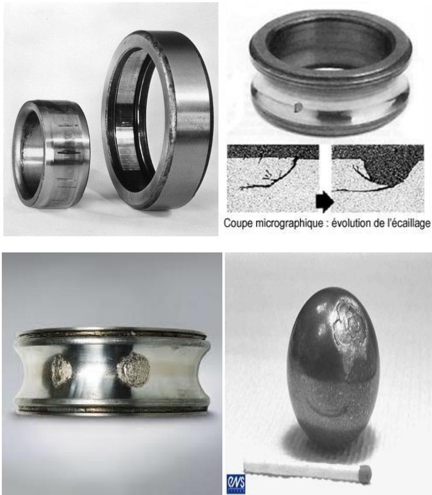
**Figure 3.24.** Défauts de roulements [40]
