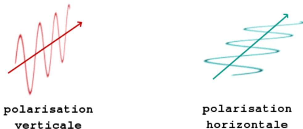
Figure 2.13 Direction de polarisation.
