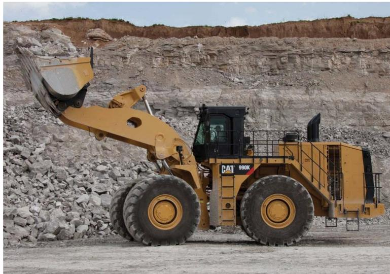
**Figure I.2 : Chargeuse sur pneumatiques**
