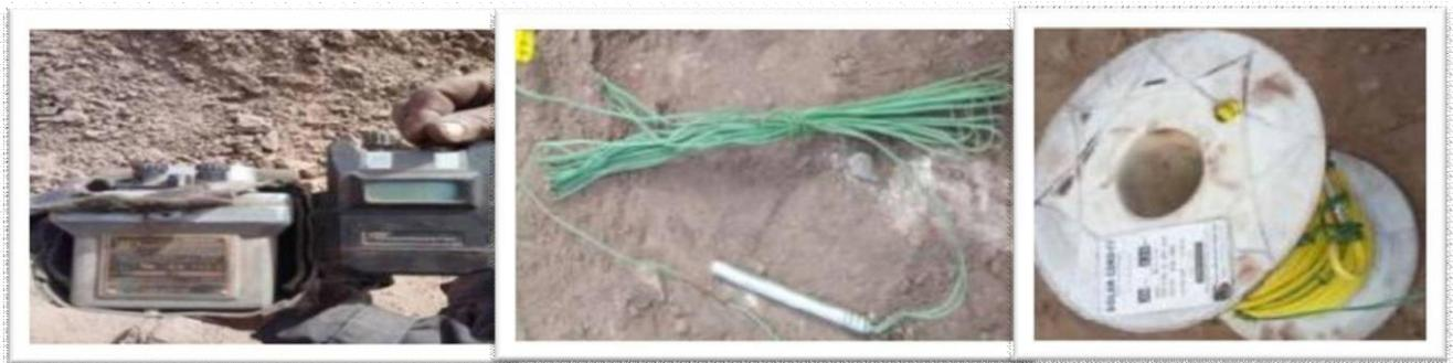
Figure I. 12 : Exposeur électrique/ DMR / Cordeau détonant
