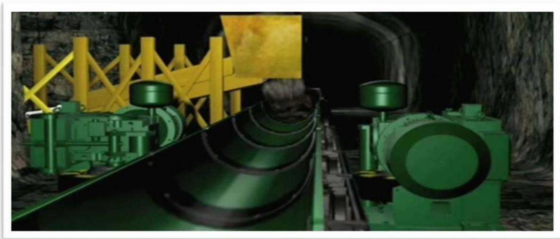
**Figure III. 8 :** chargement de Rail-Veyor avec une goulotte
