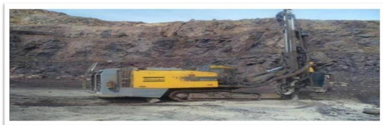
**Figure.I.8** : sondeuse de type atlas copco ROC L8 – 2-2008
