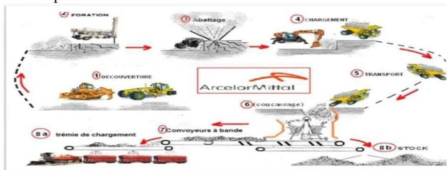
**Figure.I.5. :** les étapes d'extraction de minerai de fer de la mine de l'Ouenza
