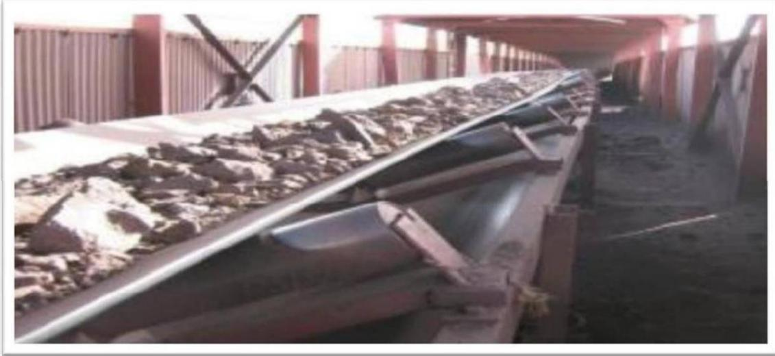
**Figure. II .20:** convoyeur à bonde
