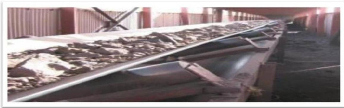
**Figure.I.16** : convoyeur à bande
