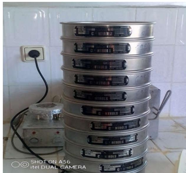
Figure III.6 : Tamis utilisés pour le tamisaie des échantillons
