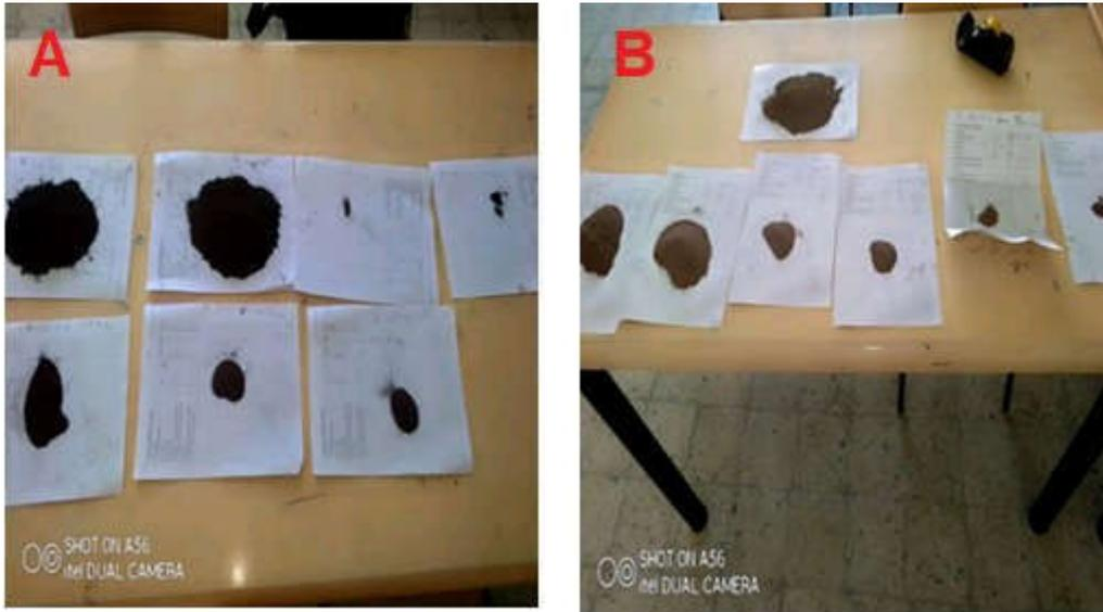
Figure IV.1 Résultat de tamisage du : A) concentré et B) rejet de fer d'el-Ouenza
