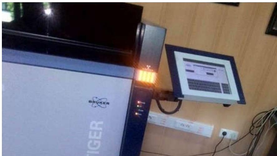
Figure III.9 : Appareil de FRX utilisé
