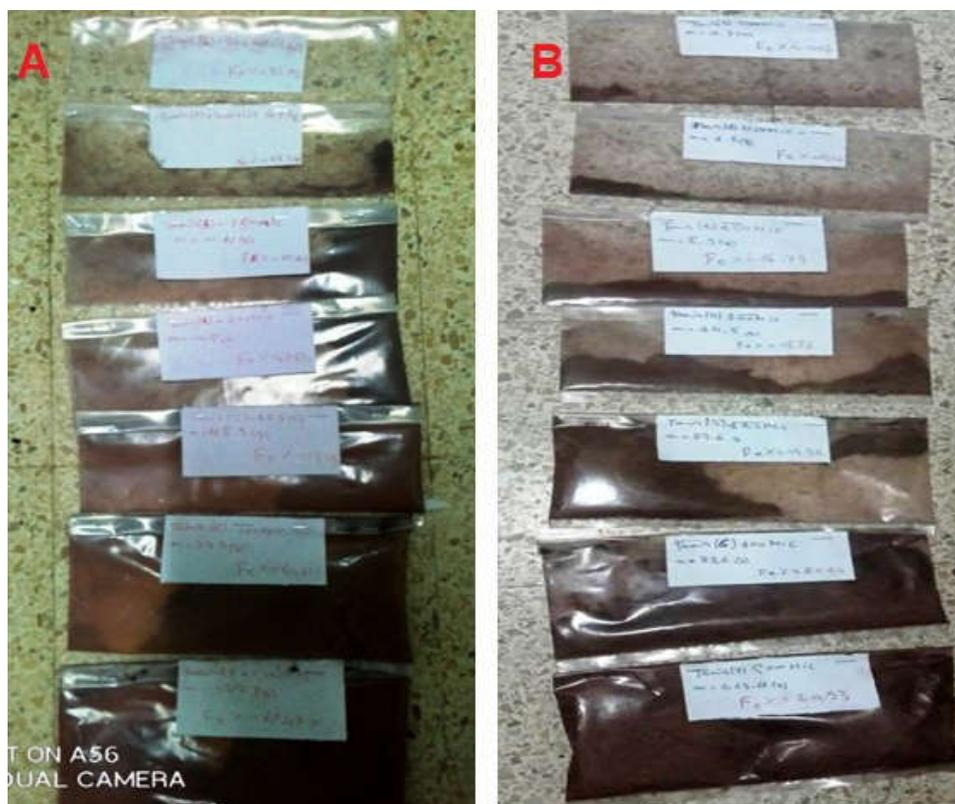
Figure IV.3 : préparation des tranches granulométriques aux analyses chimiques
