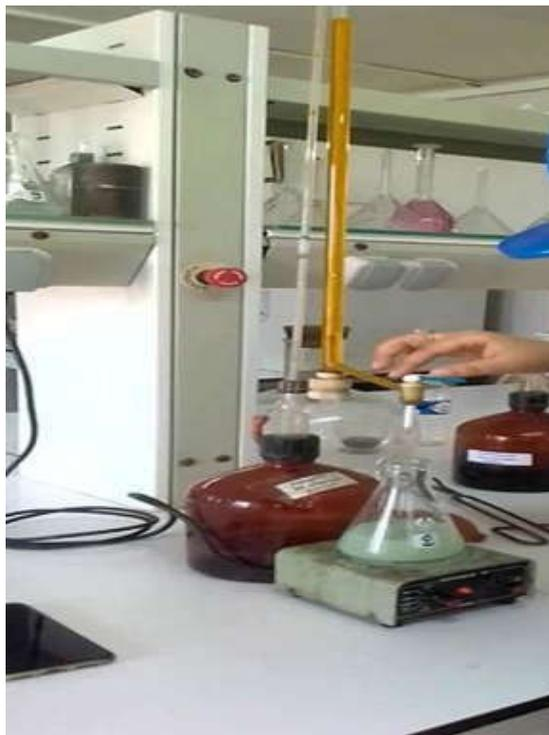
Figure III.7 : Agitateur magnétique
