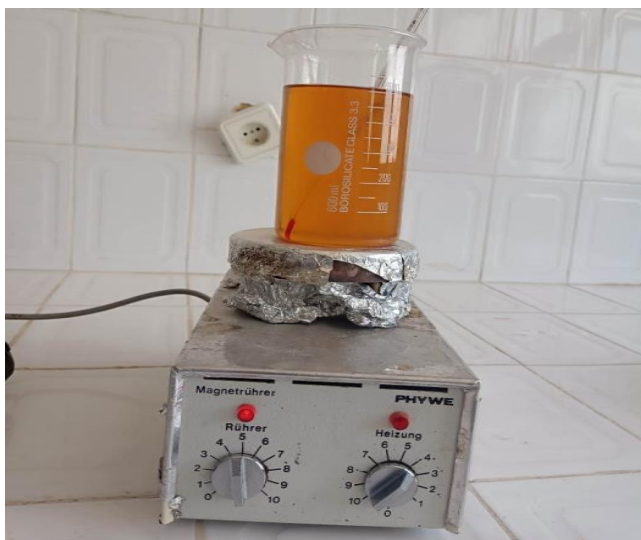
Figure III.4. Chauffer l'huile à 60c°
