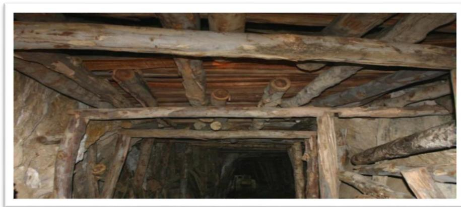
**Figure II.15 :** Cadre en bois de soutènement appliqué dans la mine d'Ain Mimoun. [21]
