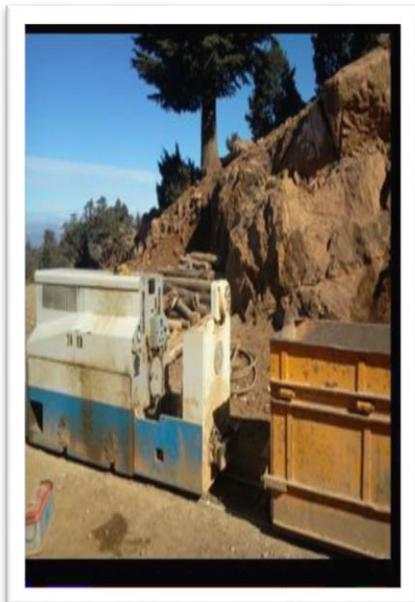
**Figure II.12** : Loco tracteur (diésel) [14]
