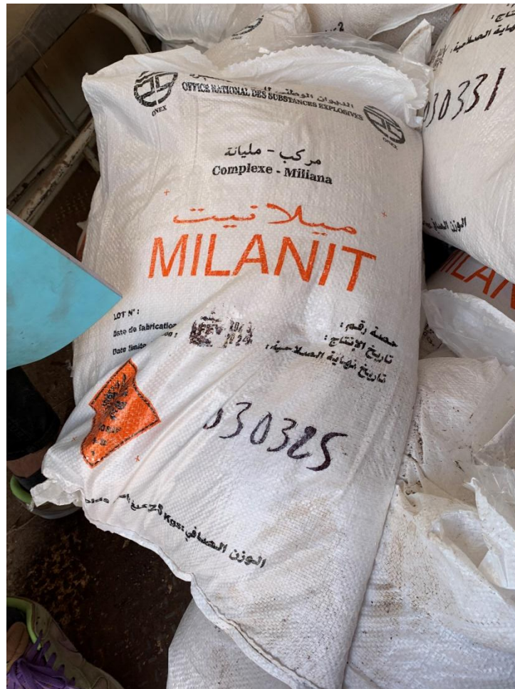
Figure 5.6 : Sac à deux couches emballé par explosif type « Milanit » de 20kg
