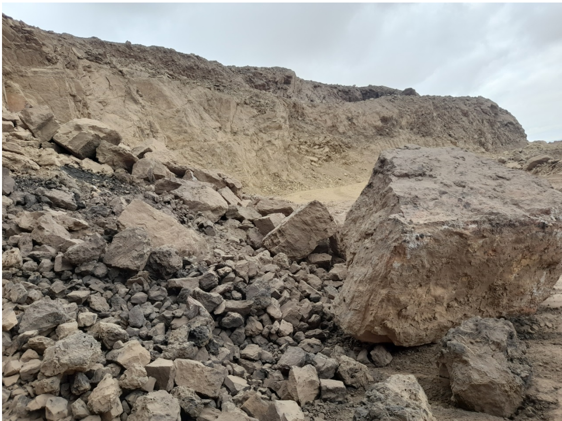
Figure III .8 : Tas de roches après le tir
