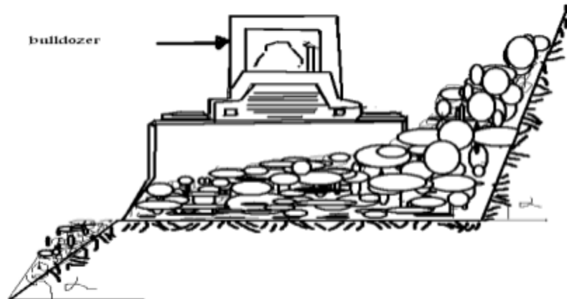
Figure II. 2 : 4 ème étape de creusement de la demi-tranchée d'accès
