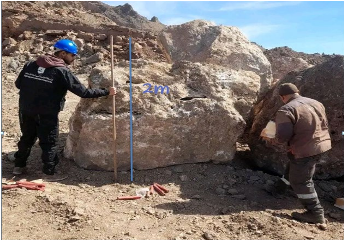
Figure III. 9 : Bloc à débiter
