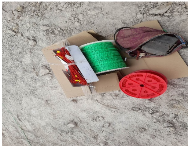
Figure II.13: Accessoires de tir (cordeau détonant 12g/m ; fil électrique ; D.E.M.R)
