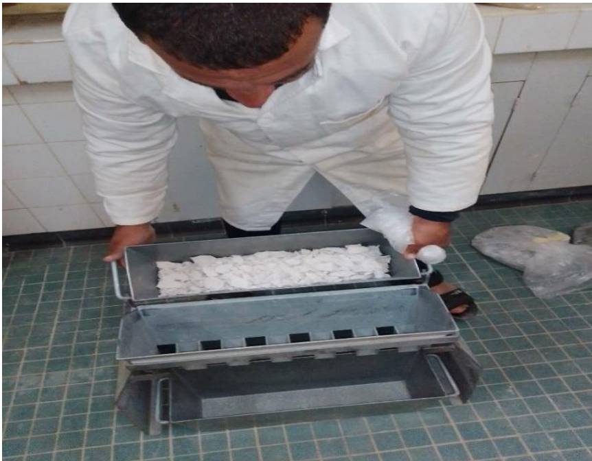
Figure 16 : photo montrant une opération d'homogénéisation
