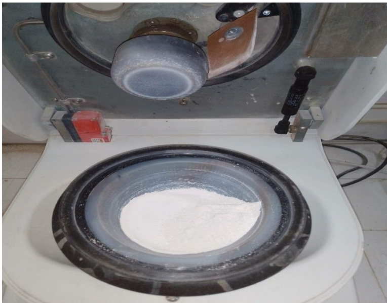
Figure 18 : Photo montrant le broyeur utilisé pour le broyage de l'échantillon
