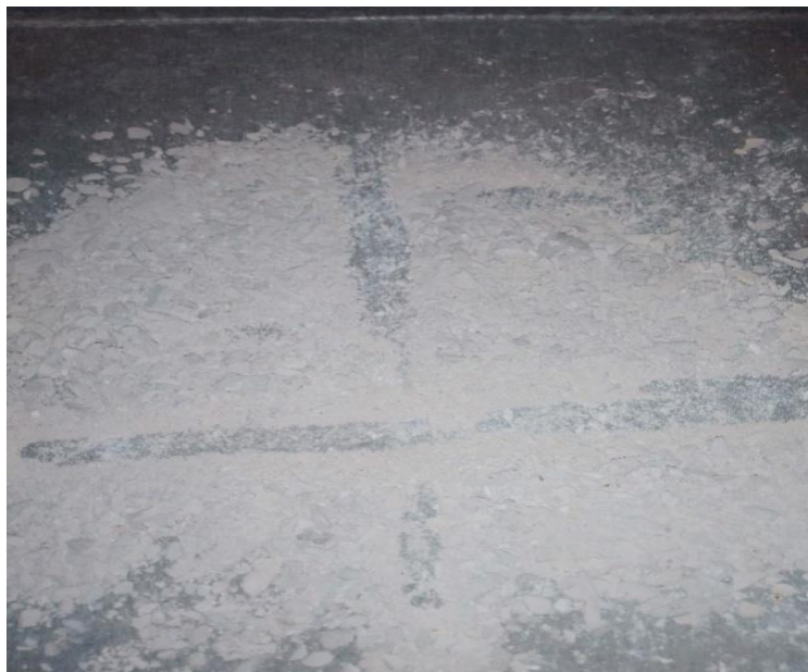
Figure 17 : Photo montrant l'opération de quartage
