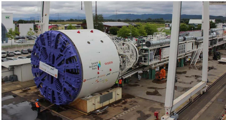
Figure I.12. Machine à attaque globale (tunnelier) [7]
