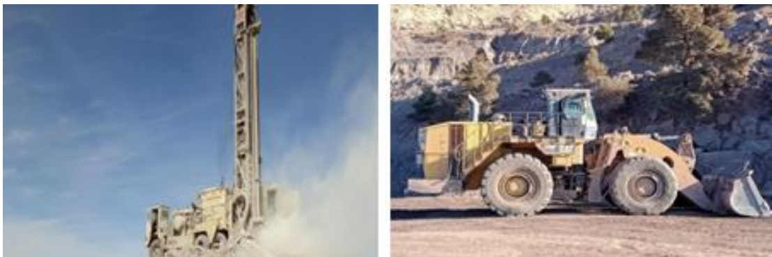
Figure II.8. Sondeuse de type I-RAND I4BH et Chargeuse de type Caterpillar
