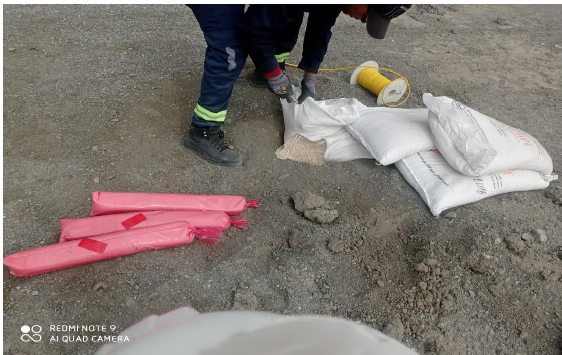
Figure V.6 : L'explosif utilisé dans Kef Essenoun ( marmanite et anfomile )
