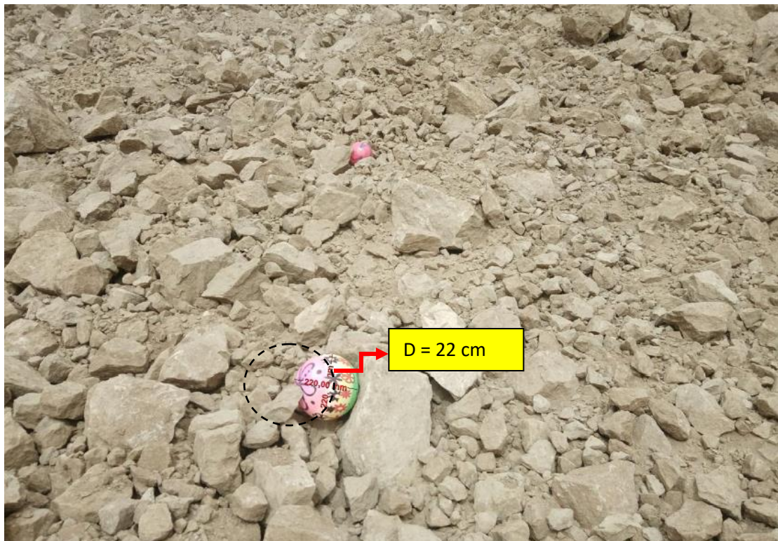
Figure V.2: Résultats de tir du stérile du 20-03-2023
