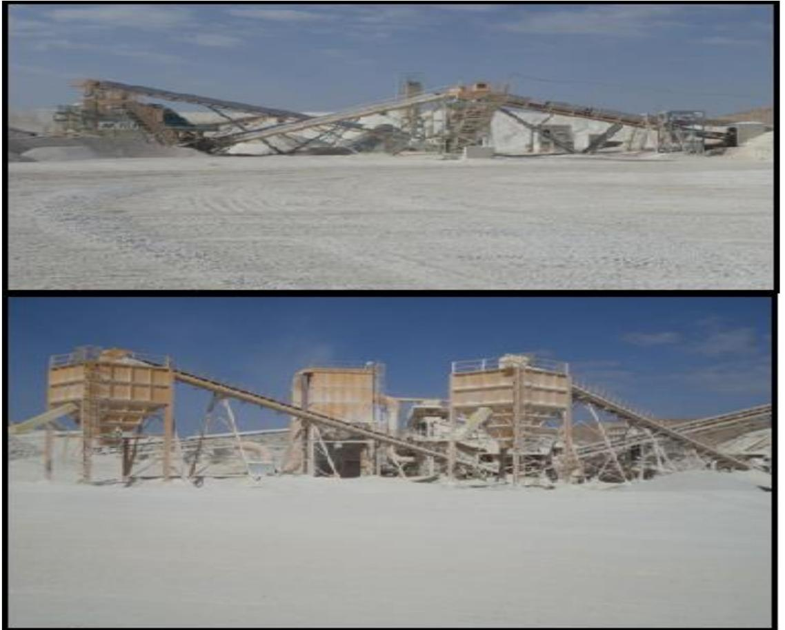
**Figure II.5.** Station secondaire de traitement.
