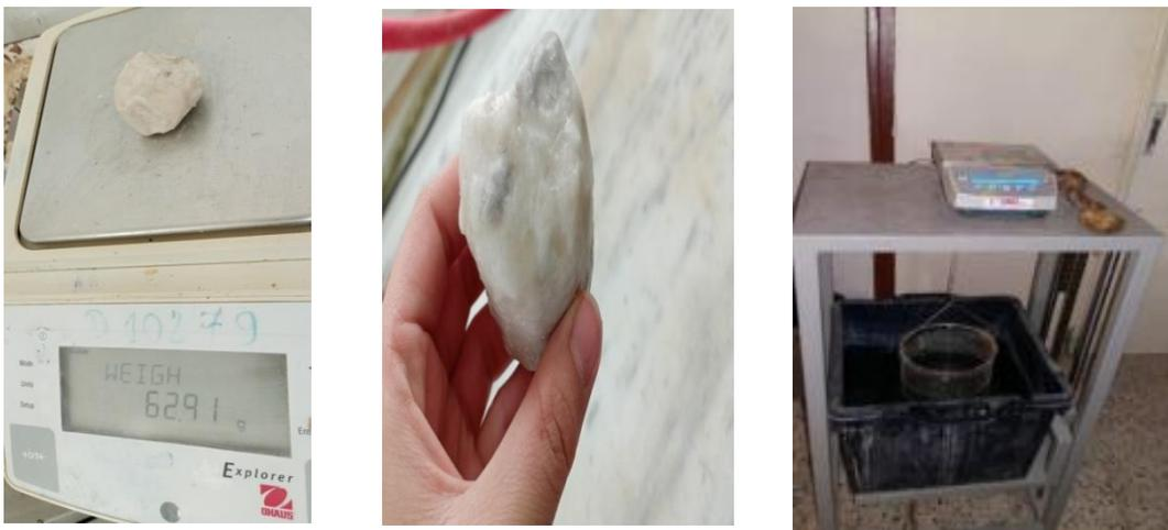
**Figure IV.2.** Préparation des échantillons dans le panier de la pesée hydrostatique.
