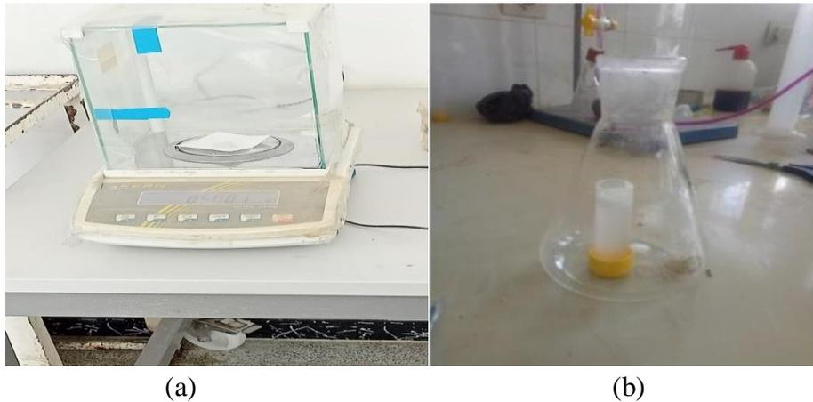
**Figure IV.6.** Préparation la mesure (a-pesé de l'échantillon, b- introduction de l'échantillon et l'HCL dans l'erenmeyer).
