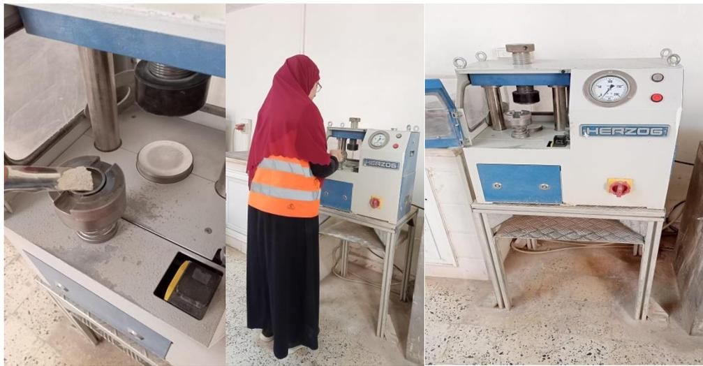
**Figure IV.10.** Mettre une pastille propre dans le dispositif de pastilleuse et remplir par la matière broyée puis niveler, passer sur presse HERZOG sous une pression de 150 KN.
