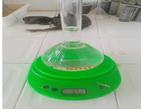
D- Masse du pycnomètre et l'échantillon
