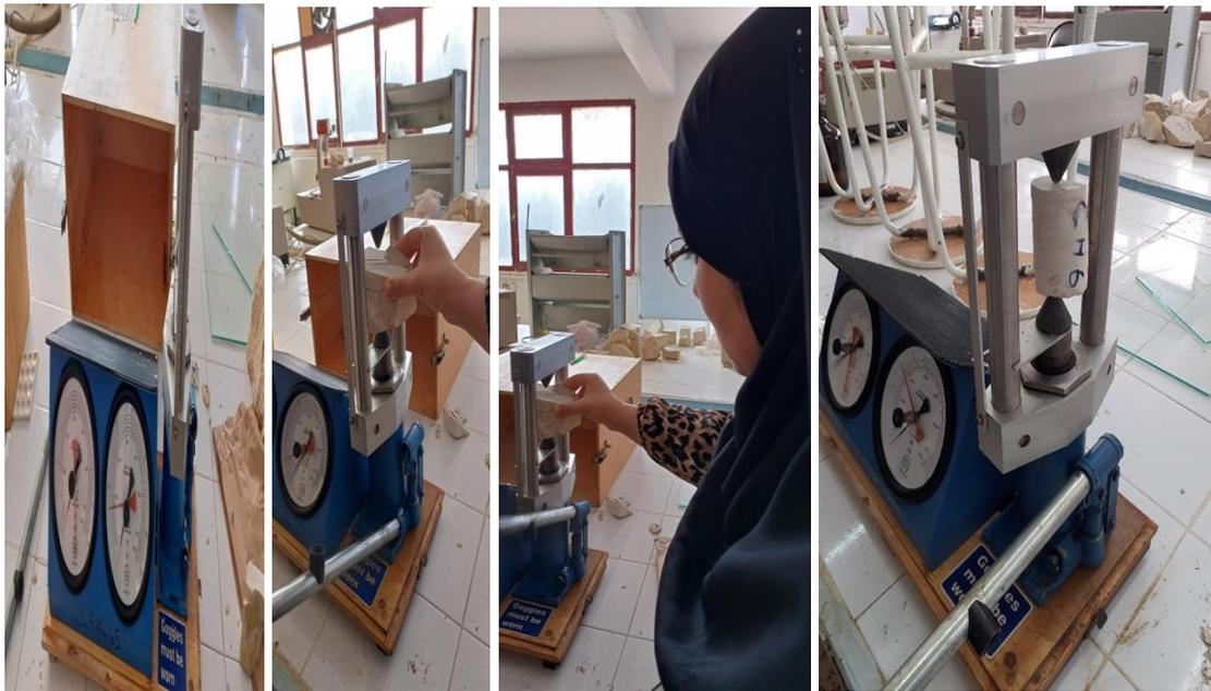
**Figure IV.14.** Réalisation d'essai franklin.
