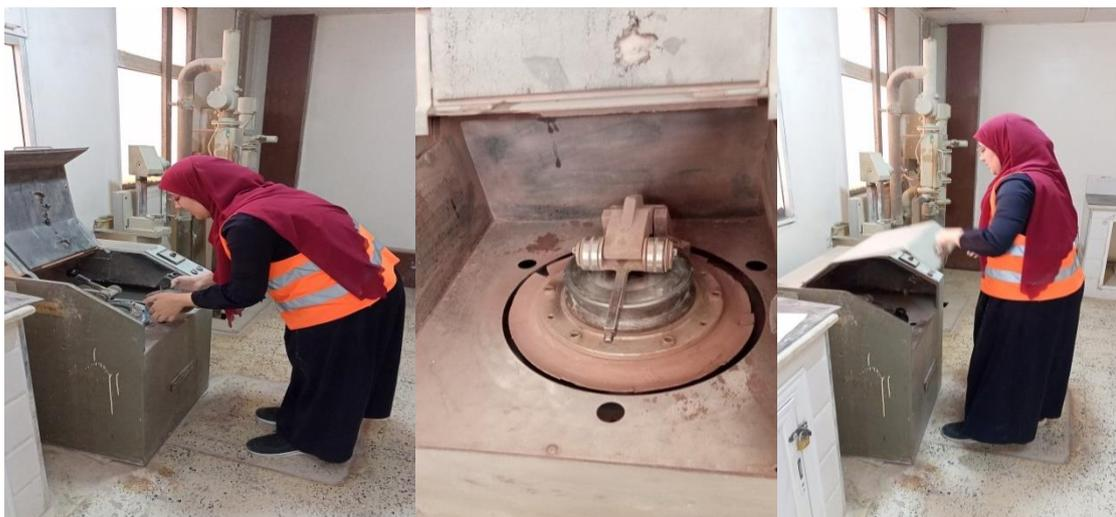
**Figure IV.8.** Placer le récipient dans le broyeur et bien fermer le couvercle, à l'aide de la minuterie, régler le temps de broyage à 4 minutes et broyer.
