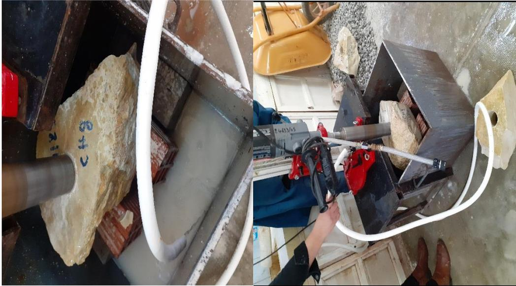
**Figure IV.13.** Préparation des échantillonnages en utilisant la carotteuse.
