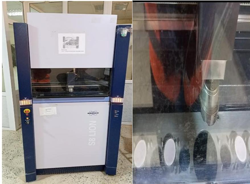
**Figure IV.12.** Placer la pastille dans le porte échantillon de l'analyse à fluorescente X (PW 1660).
