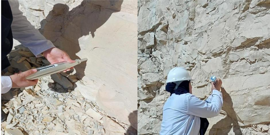
**Figure IV.16.** Mesure la résistance par scléromètre.
