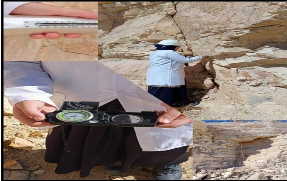
**Figure V. 4.** Mesure des différents paramètres du RMR sur terrain.
