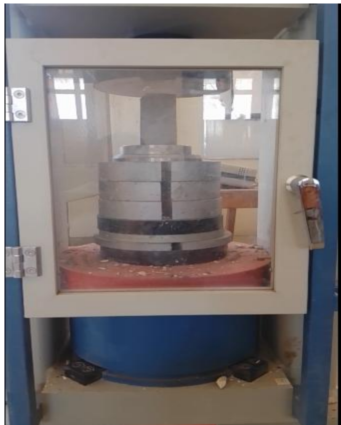
Figure 4.4 : Écrasement des échantillons au laboratoire par presse hydraulique.
