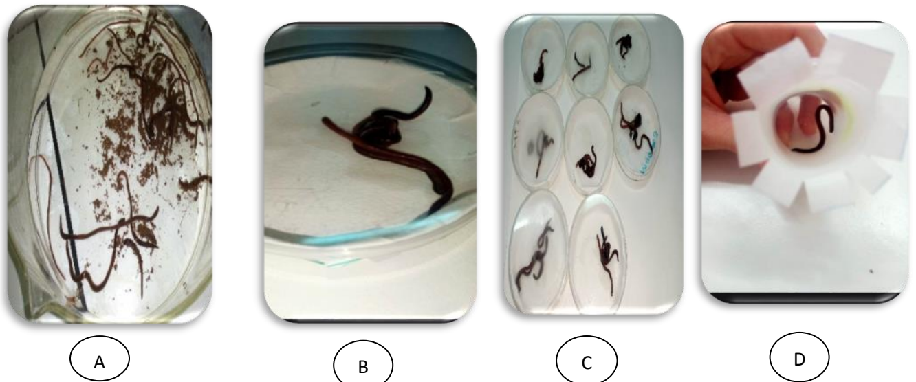
Figure 12. Les étapes du test, A /rinçage du vers de terre avec l'eau de robinet ; B /Essuyage du vers de terre ; C /Mettre les vers de terre dans un boîte de pétri avec un papier filtre pour vider leurs estomacs ; D /mettre un vers dans une fiole cylindrique dont les bords intérieurs sont couverts avec du papier filtre imbibé d'insecticide Phoenix (Photo personnelle 2023)
