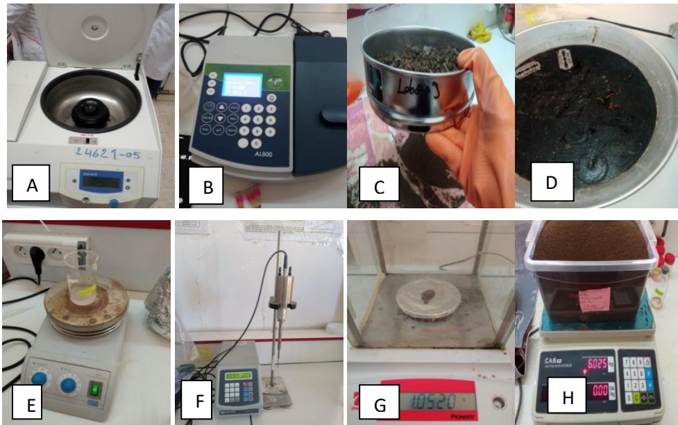
Figure 11 : le matériel utilisé dans laboratoire A) centrifugeuse B) spectrophotomètre C) le tamis D) blanche de dissection E) agitateur F) l'homogénéiseur G) balance digital H) balance électronique
