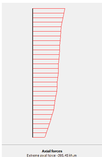
Figure 4.19 : Courbe d'effort axiale dans le pieu en 1 er cas (sans chargement).
