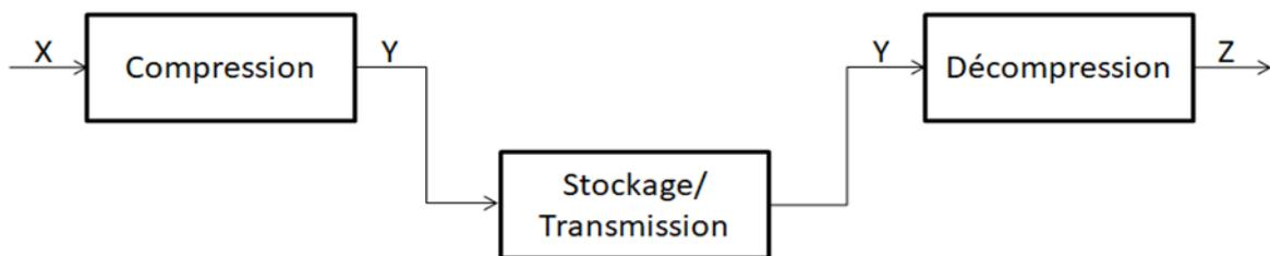
Figure I. 1Principe de compression avec perte [2]
