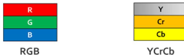
Figure I. 3étape 1 de la compression JPEG (Transformation de couleurs) [14]
