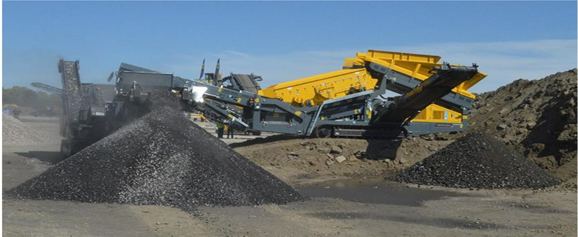
Figure II.15. Matériaux recyclés en asphalte
