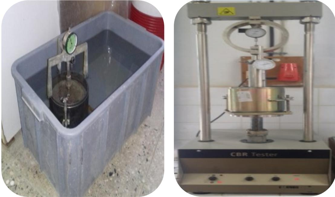
**Figure V.5.** Immersion pendant 4 jours dans l'eau et poinçonnement
