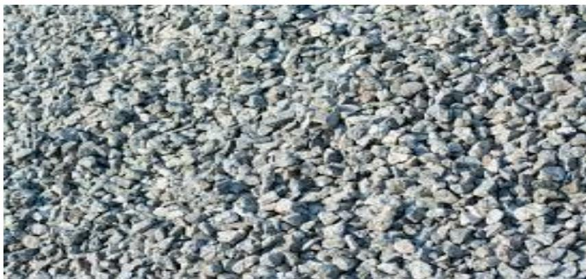
**Figure II.11.** Pierres concassées pour la construction de routes
