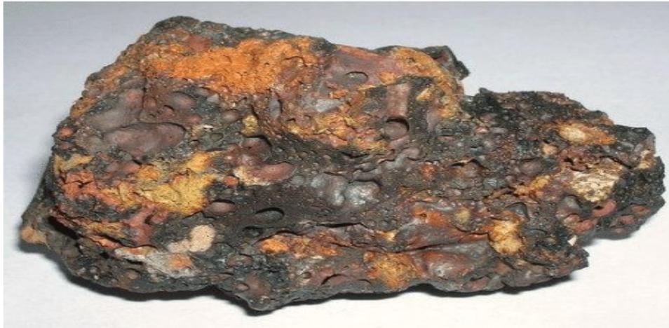
**Figure II.7.** Le laitier en tant que sous-produit du four de fabrication de l'acier
