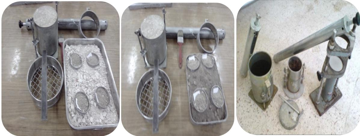
Figure IV.10. Essai Proctor modifié pour Type 1: calcaire phosphaté et Type 2: calcaires
