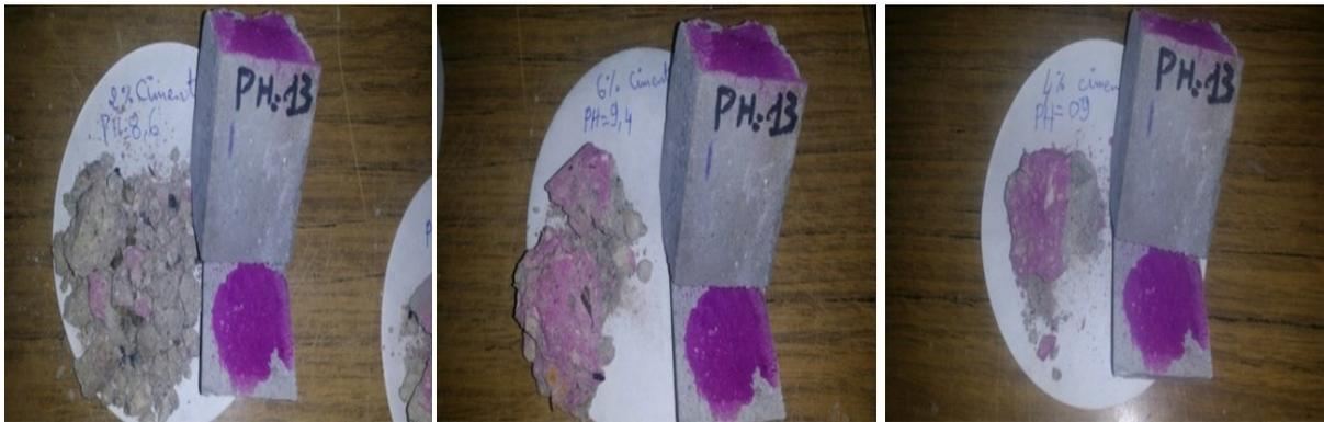
Figure V.9. Echantillons de type calcaire phosphaté mis en test d'un indicateur coloré
