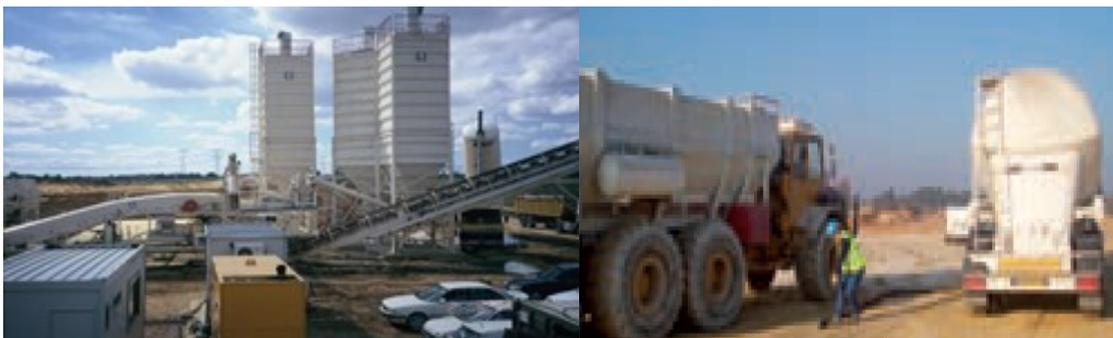
**Figure III.7.** Traitement en centrale : installation fixe et traitement en place
