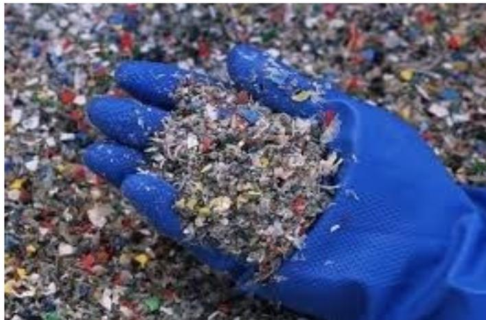
Figure II.12. Utilisation de déchets plastiques dans la construction de routes
