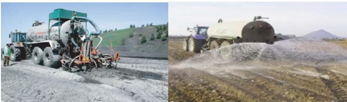
**Figure III.10** Arroseur enfouisseur avec citerne attelée sur tracteur et arroseuse
