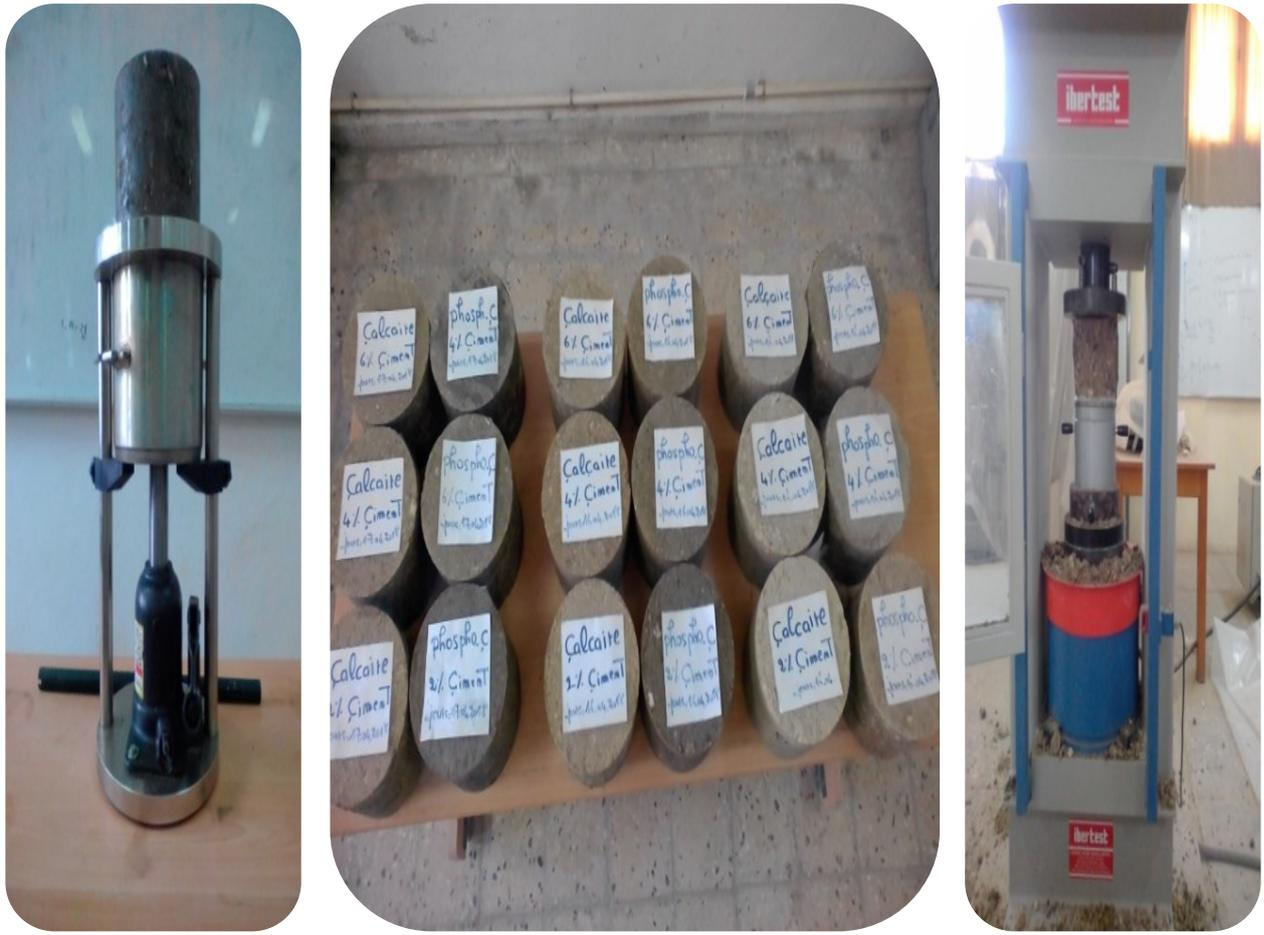
Figure V.11. Préparation des éprouvettes et rupture des échantillons sous un test de compression simple
