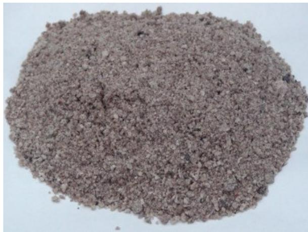
**Figure II.6.** Laitier granulé de haut-fourneau broyé
