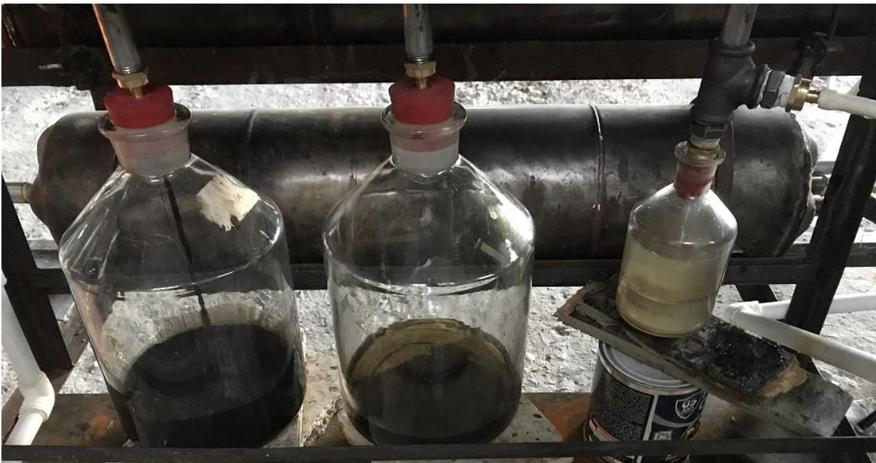
Figure 4.6 Prototype expérimentale de pyrolyse (carburant résultant).
