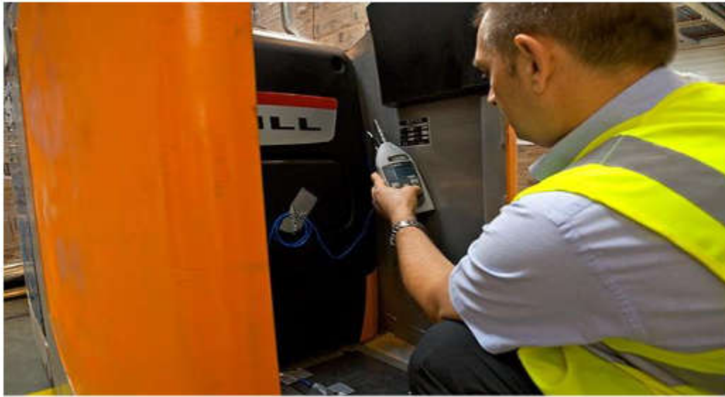
Figure 5.2 Mesure des vibrations produites par un transpalette avec un vibromètres
