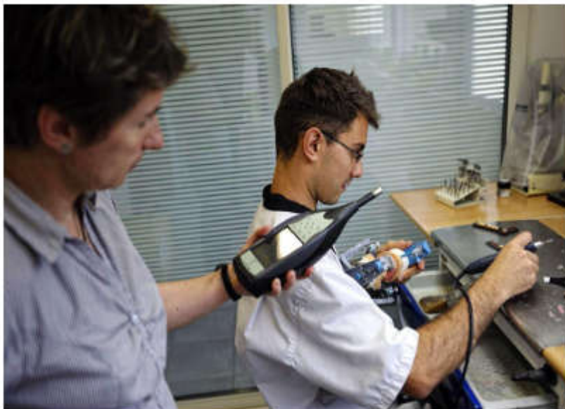
Figure 5.1 Mesure de niveau sonore à l'aide d'un sonomètre
