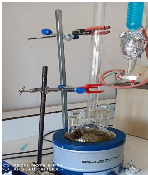
Figure 21 : Montage d'un appareil d'hydrodistillation de type Clevenger.
