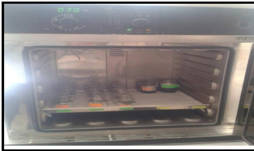
**Figure 19 :** Séchage de l'extrait dans l'étuve (photo personnelle).
