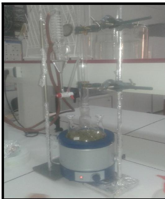
**Figure 21** : Montage d'hydrodistillateur type Çlevenger (photo personnelle).
