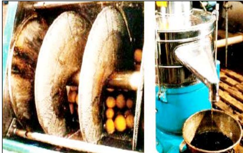
Figure 6: Expression à froid des huiles essentielles (Web1)
