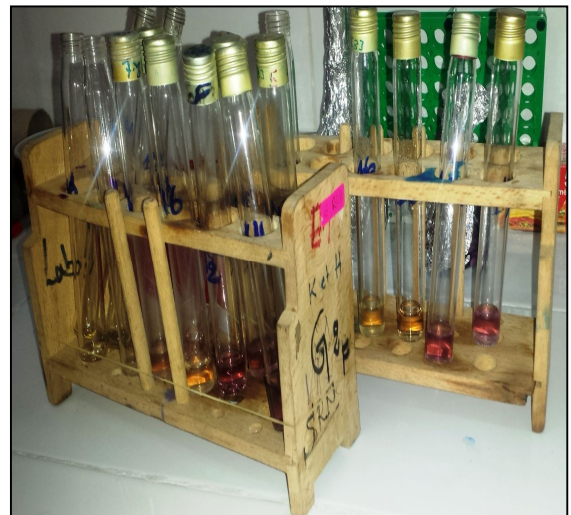
Réaction de DPPH avec les dilutions de l'HE, déposé 30 min à l'obscurité
