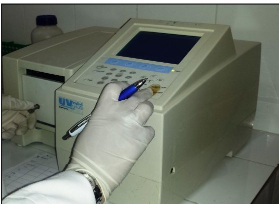
Lecture de la densité optique à 517 nm
