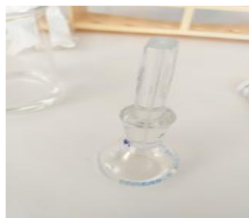
Figure 16 : Pycnomètre en verre pour la mesure de la densité relative (photo personnelle).
