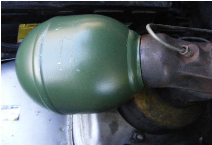
Figure 1.6 : suspension hydropneumatique [14]
