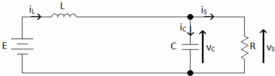
Figure II.12 Schéma du hacheur Boost quand l'interrupteur est ouvert
