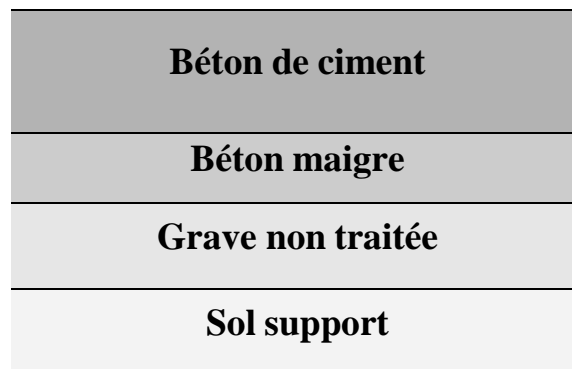
Figure 3 : 2.7 Corps de chaussée rigide
