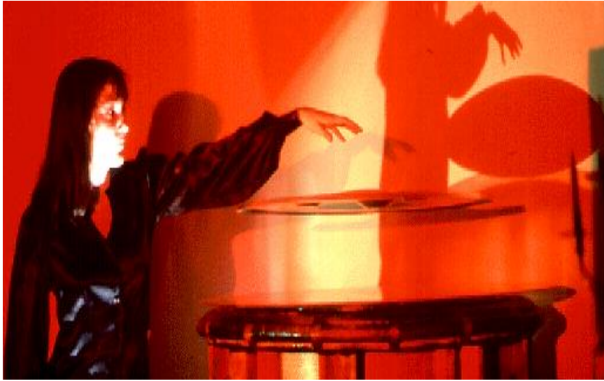
Figure I.7 : Exemple de Lévitation électrodynamique par courant alternatif.
